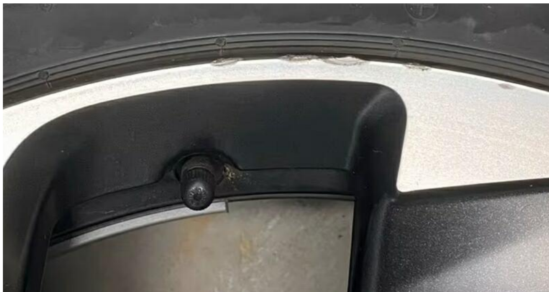
Bild 22 : Alufelge vorne rechts, glanzgedreht, zerkratzt
