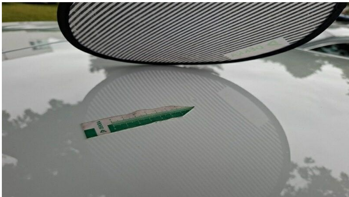
Bild 20 : Dach, mehrfach eingedellt, drücken
