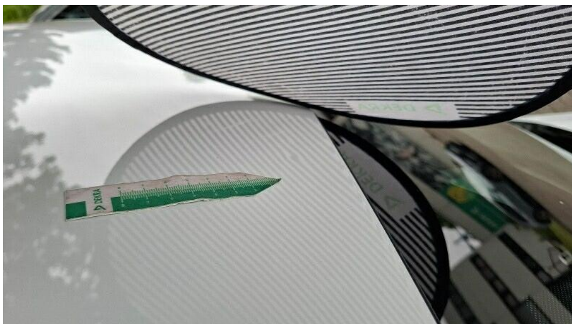
Bild 19 : Dach, mehrfach eingedellt, drücken
