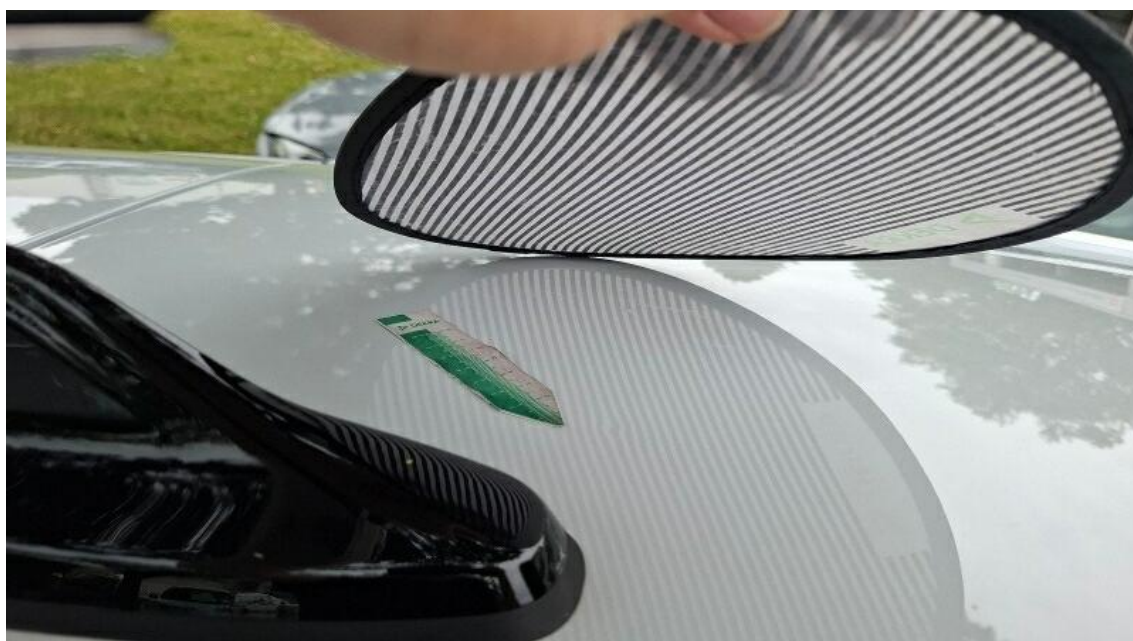
Bild 21 : Dach, mehrfach eingedellt, drücken
