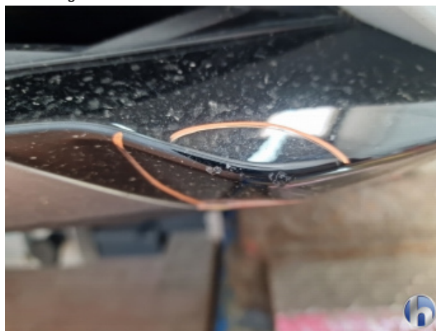
1. Frontspoiler Beschädigt - Lackieren
