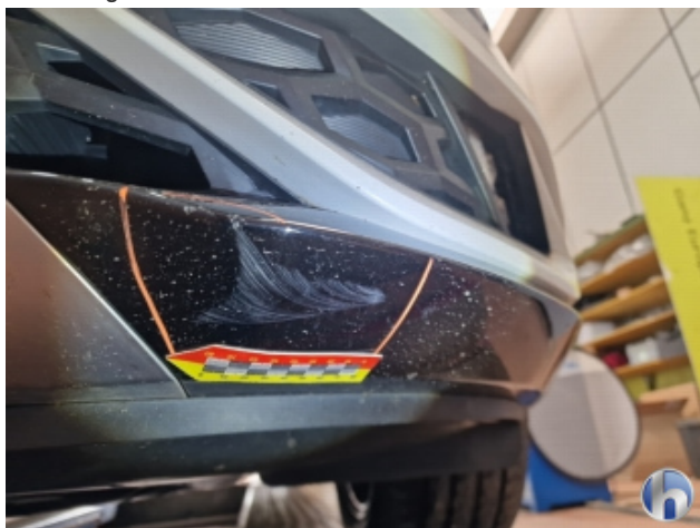
1. Frontspoiler Beschädigt - Lackieren
