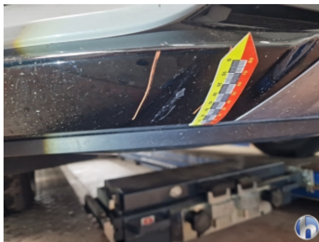
1. Frontspoiler Beschädigt - Lackieren
