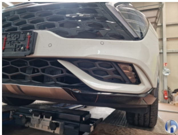
1. Frontspoiler Beschädigt - Lackieren
