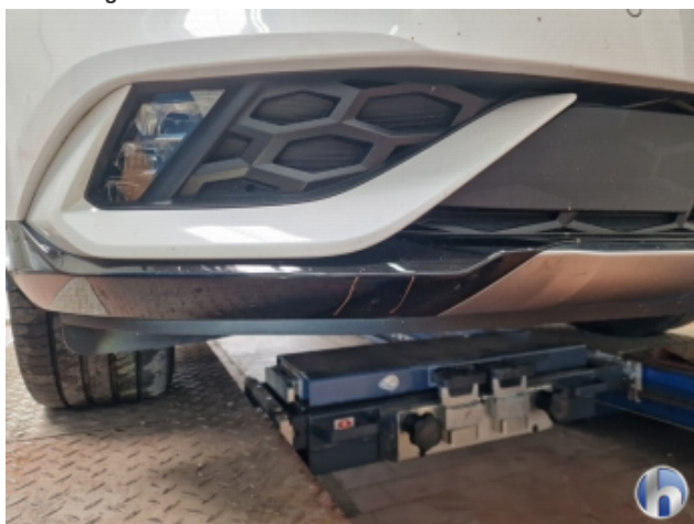
1. Frontspoiler Beschädigt - Lackieren
