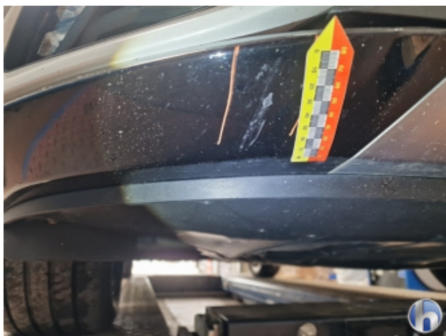
1. Frontspoiler Beschädigt - Lackieren
