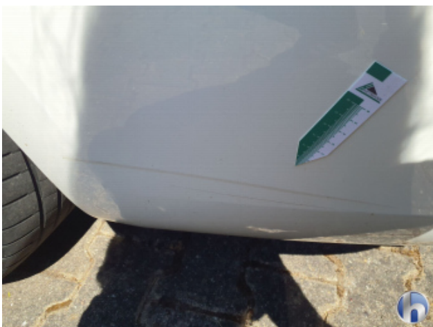
5. Stoßfänger Hinten Beschädigt - Siehe Kalkulation
