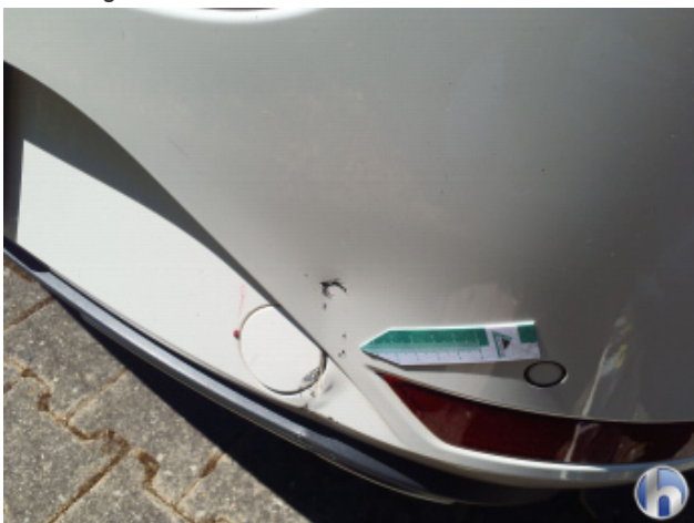
5. Stoßfänger Hinten Beschädigt - Siehe Kalkulation
