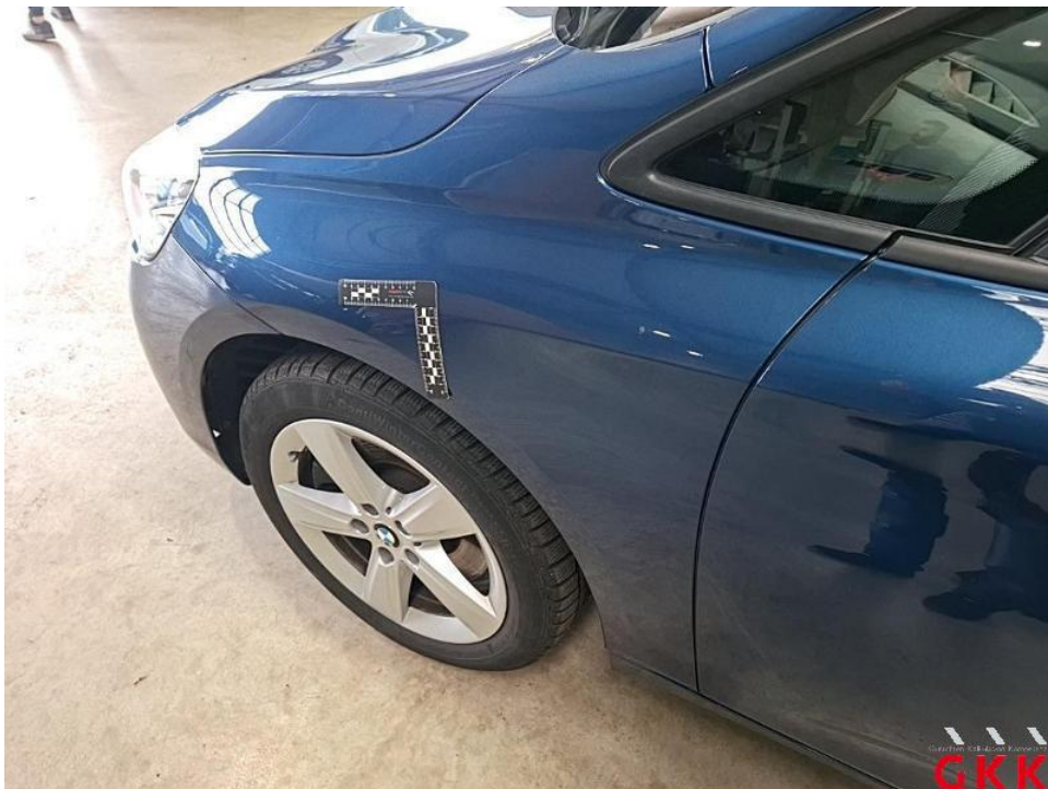
Bild 16. Kotflügel vorne links, Reparaturmangel, aufbereiten
