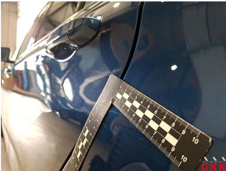
Bild 24. Tür hinten links, Reparaturmangel, aufbereiten
