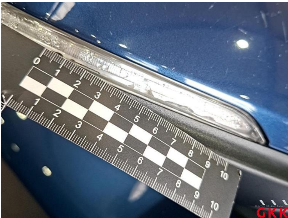
Bild 44. Spiegelgehäuse rechts, Blinker, beschädigt, ersetzen
