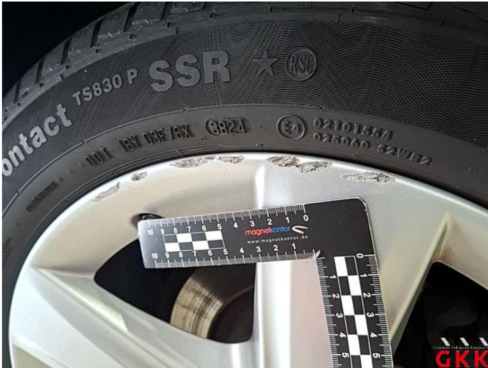
Bild 30. LM-Rad, hinten links, Materialabtrag, ersetzen
