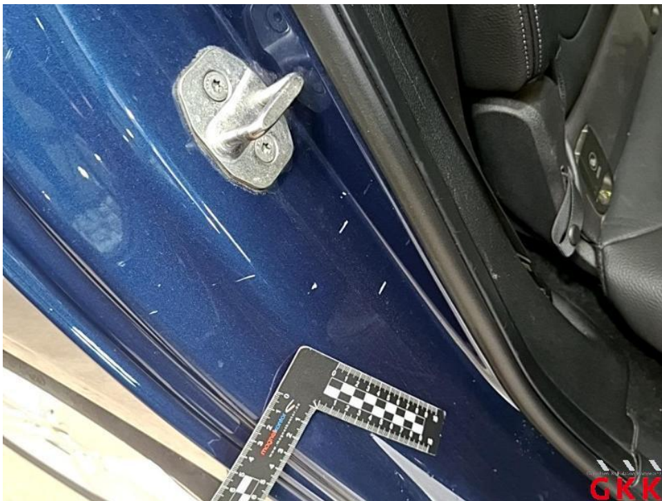
Bild 40. Tür hinten rechts, Einstieg, verkratzt, lackieren
