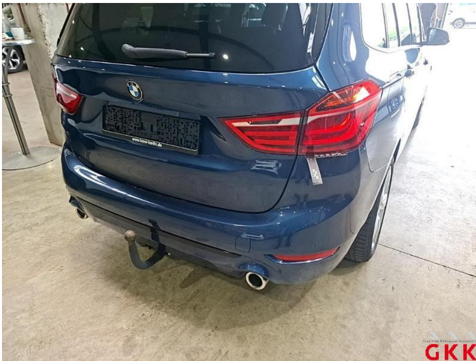
Bild 32. Stoßfänger hinten, Verkleidung -lackiert-, beschädigt, instand setzen - lackieren
