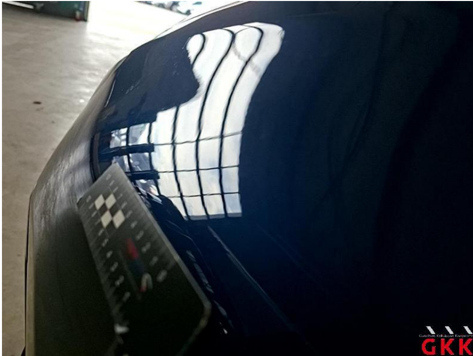
Bild 17. Kotflügel vorne links, Reparaturmangel, aufbereiten
