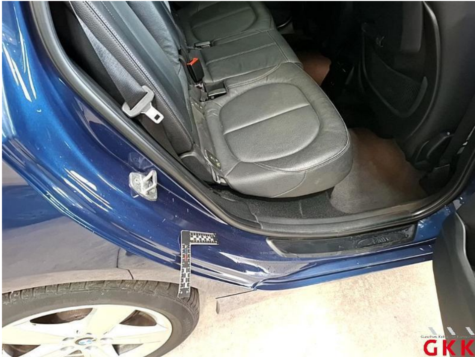
Bild 39. Tür hinten rechts, Einstieg, verkratzt, lackieren
