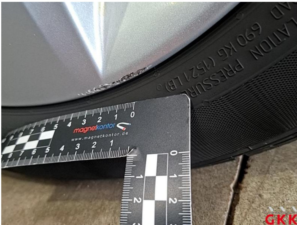
Bild 38. LM-Rad, hinten rechts, verkratzt, lackieren
