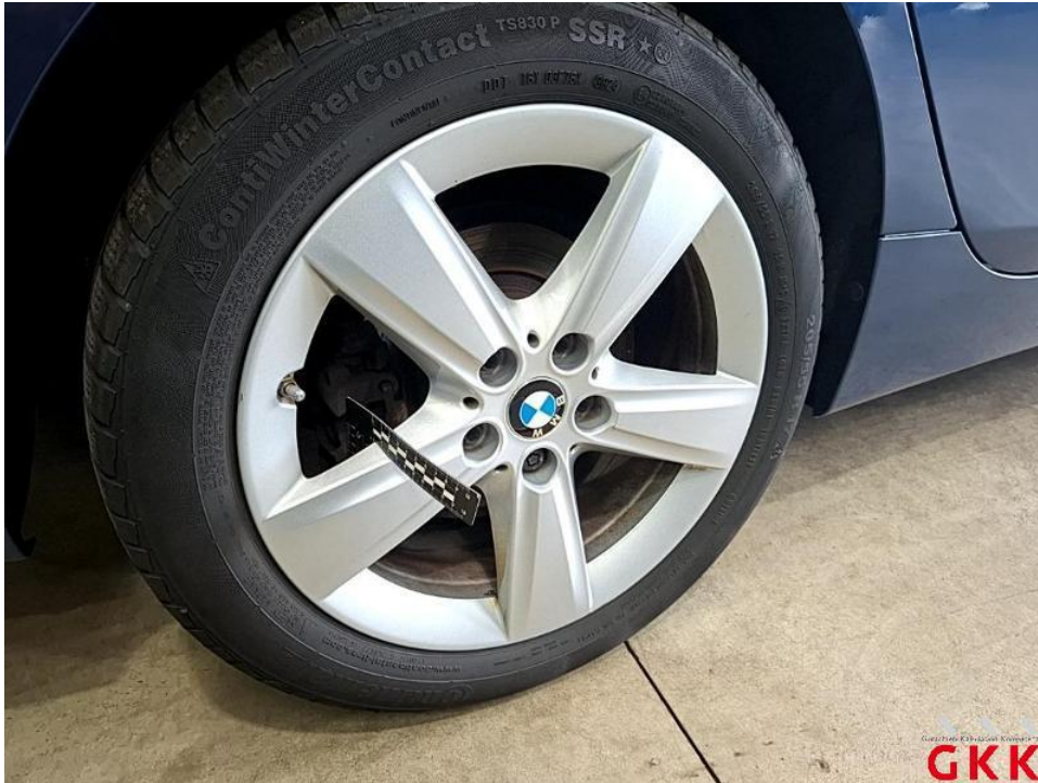
Bild 37. LM-Rad, hinten rechts, verkratzt, lackieren
