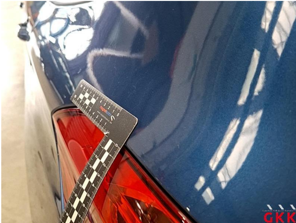
Bild 28. Seitenwand links, Reparaturmangel, aufbereiten
