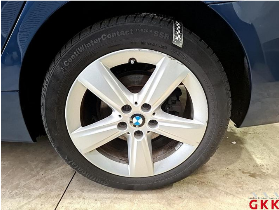
Bild 29. LM-Rad, hinten links, Materialabtrag, ersetzen
