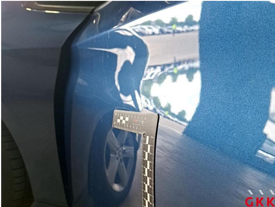
Bild 20. Tür vorne links, Reparaturmangel, aufbereiten
