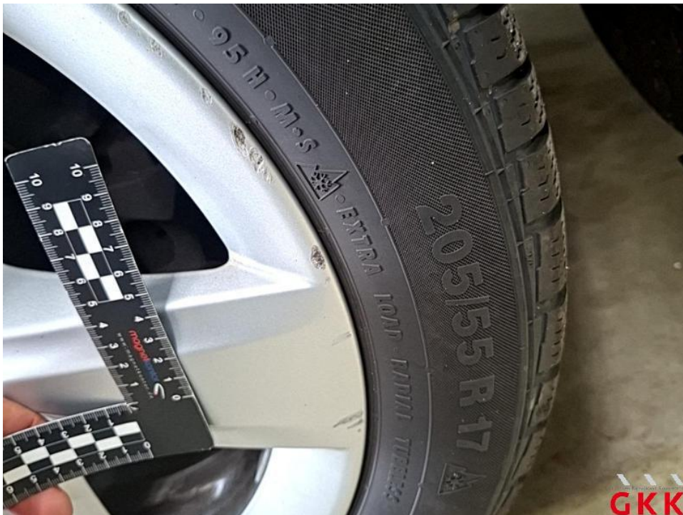
Bild 31. LM-Rad, hinten links, Materialabtrag, ersetzen
