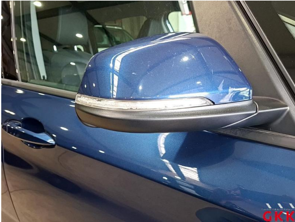
Bild 43. Spiegelgehäuse rechts, Blinker, beschädigt, ersetzen
