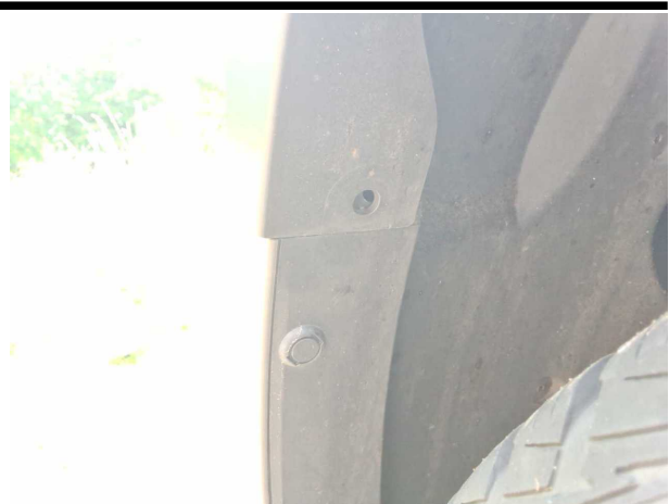
Beschädigung #3: Seitenwand rechts: Radlauf - instandsetzen
