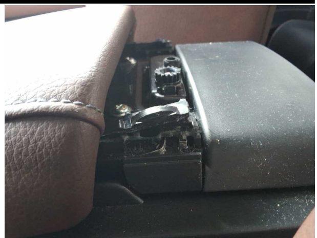
Beschädigung #7: Sitz hinten: Mittelarmlehne - beschädigt - erneuern
