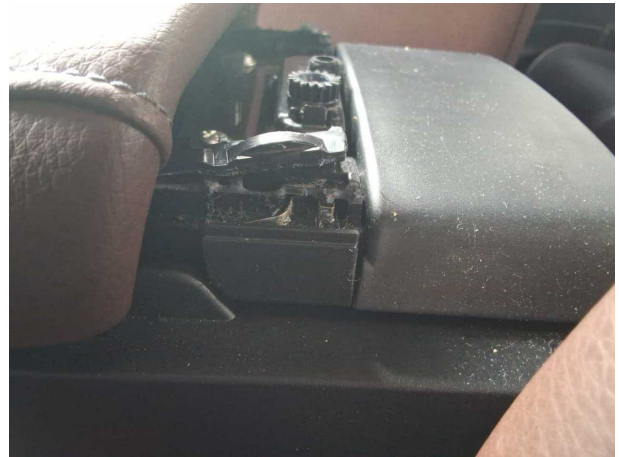
Beschädigung #7: Sitz hinten: Mittelarmlehne - beschädigt - erneuern
