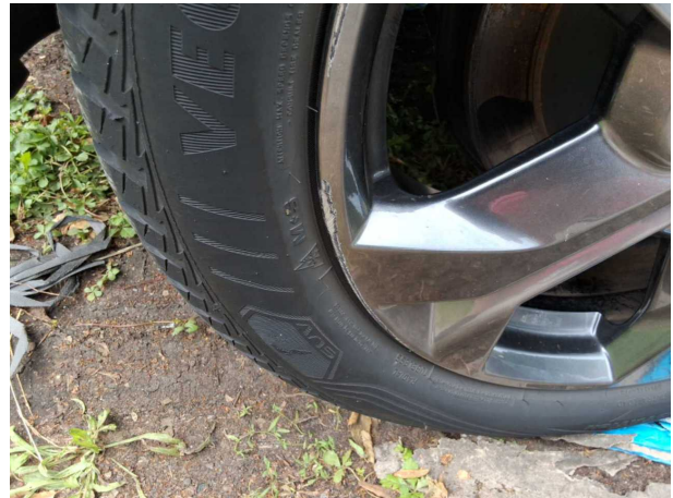
Beschädigung #8: Rad/Reifen: Leichtmetallfelge hinten rechts - Kratzer - erneuern
