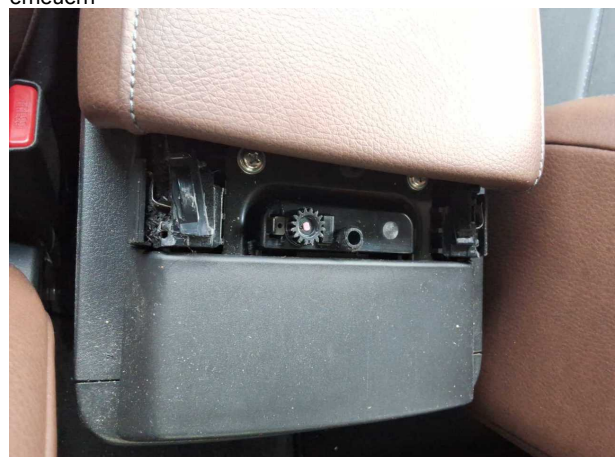
Beschädigung #7: Sitz hinten: Mittelarmlehne - beschädigt - erneuern
