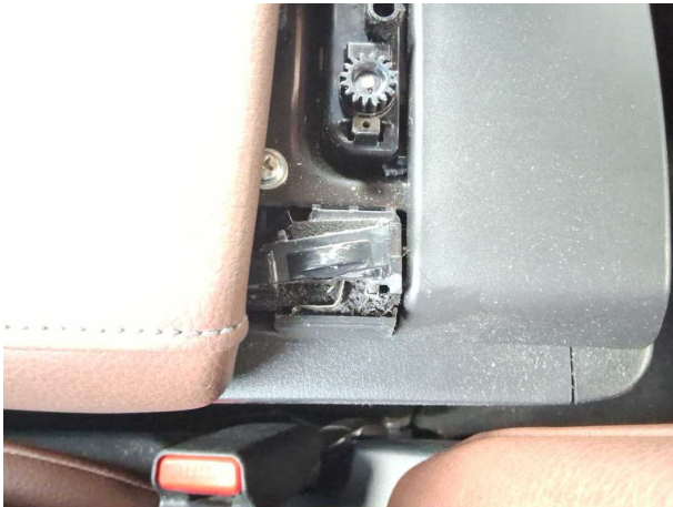
Beschädigung #7: Sitz hinten: Mittelarmlehne - beschädigt - erneuern
