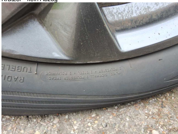
Beschädigung #2: Rad/Reifen: Leichtmetallfelge vorn rechts - Kratzer - kein Abzug
