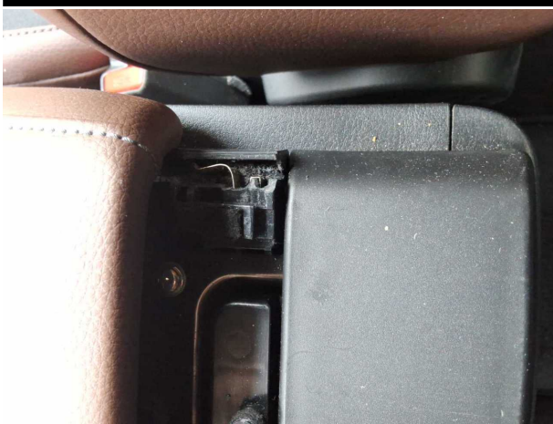
Beschädigung #7: Sitz hinten: Mittelarmlehne - beschädigt - erneuern
