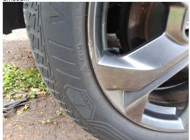
Beschädigung #8: Rad/Reifen: Leichtmetallfelge hinten rechts - Kratzer - erneuern
