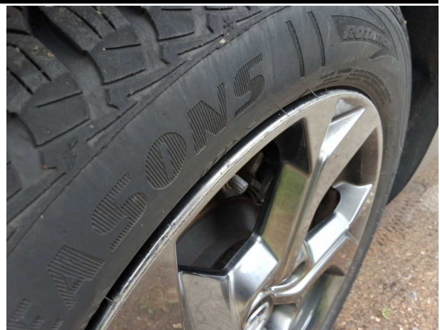
Beschädigung #8: Rad/Reifen: Leichtmetallfelge hinten rechts - Kratzer - erneuern
