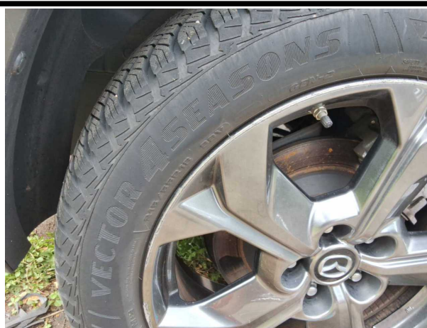
Beschädigung #8: Rad/Reifen: Leichtmetallfelge hinten rechts - Kratzer - erneuern
