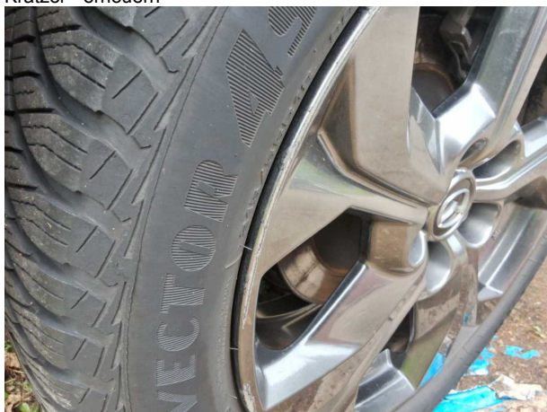
Beschädigung #8: Rad/Reifen: Leichtmetallfelge hinten rechts - Kratzer - erneuern
