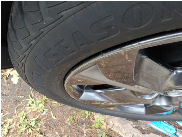
Beschädigung #8: Rad/Reifen: Leichtmetallfelge hinten rechts - Kratzer - erneuern
