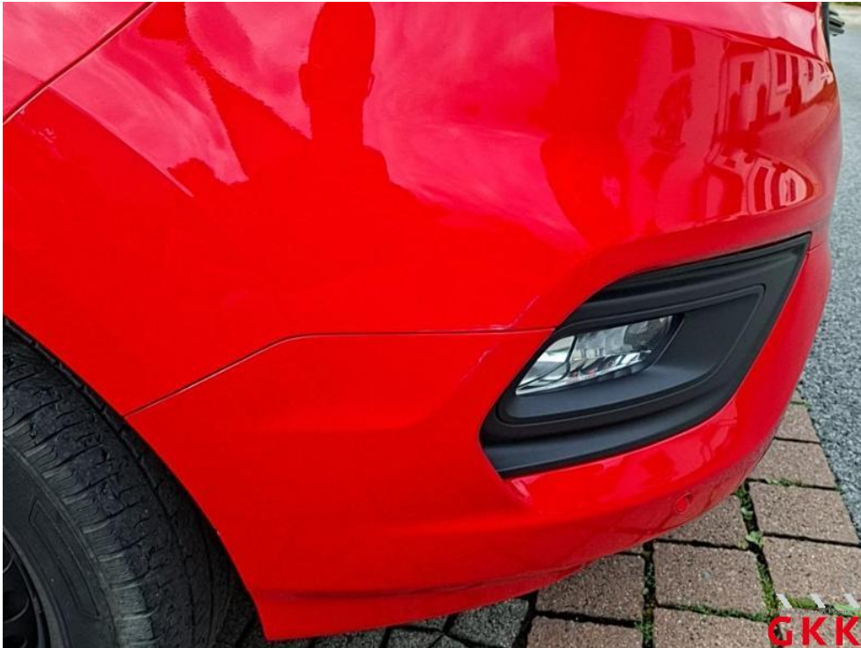
Bild 15. Stoßfänger vorne, Verkleidung unterhalb -lackiert-, verkratzt, Smartrepair
