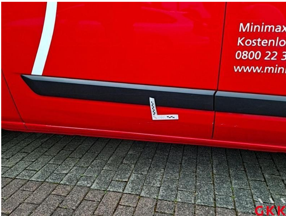
Bild 36. Schiebetür rechts, verkratzt, lackieren
