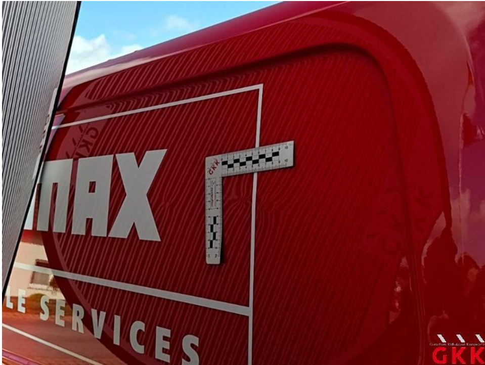
Bild 23. Seitenwand links, beschädigt, instand setzen - lackieren
