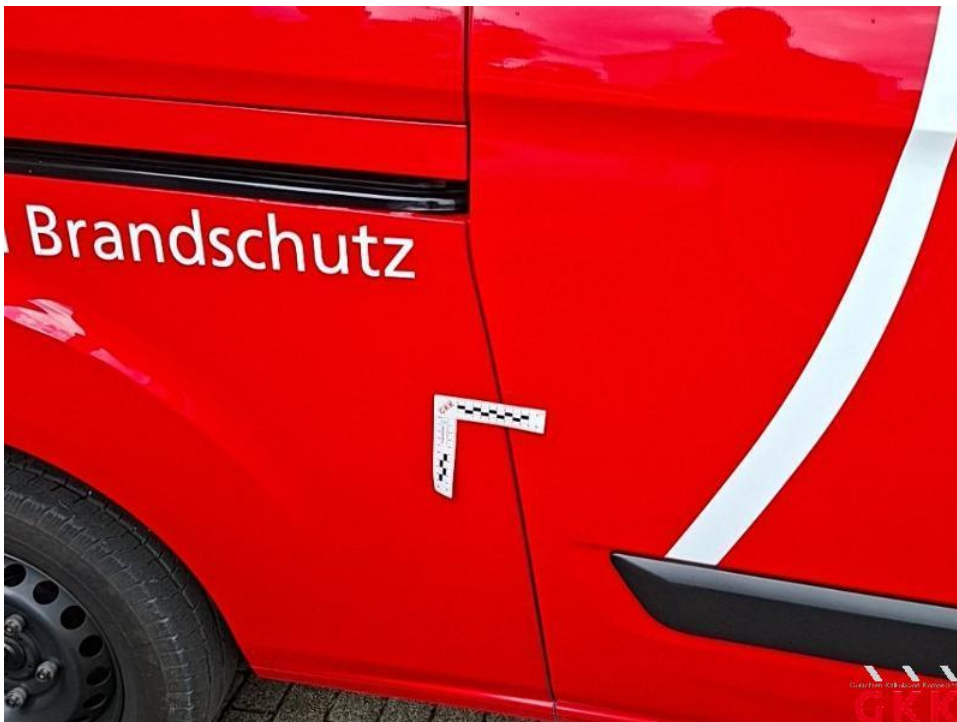
Bild 34. Seitenwand rechts, verkratzt, Smartrepair
