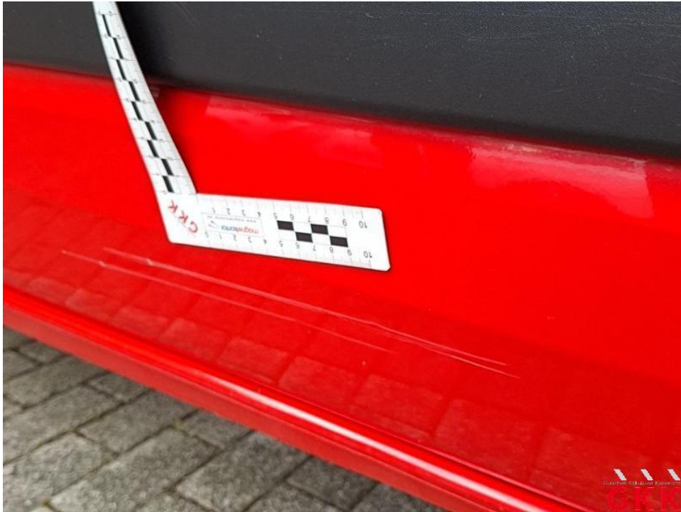
Bild 37. Schiebetür rechts, verkratzt, lackieren
