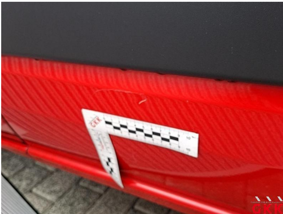
Bild 22. Seitenwand links, beschädigt, instand setzen - lackieren
