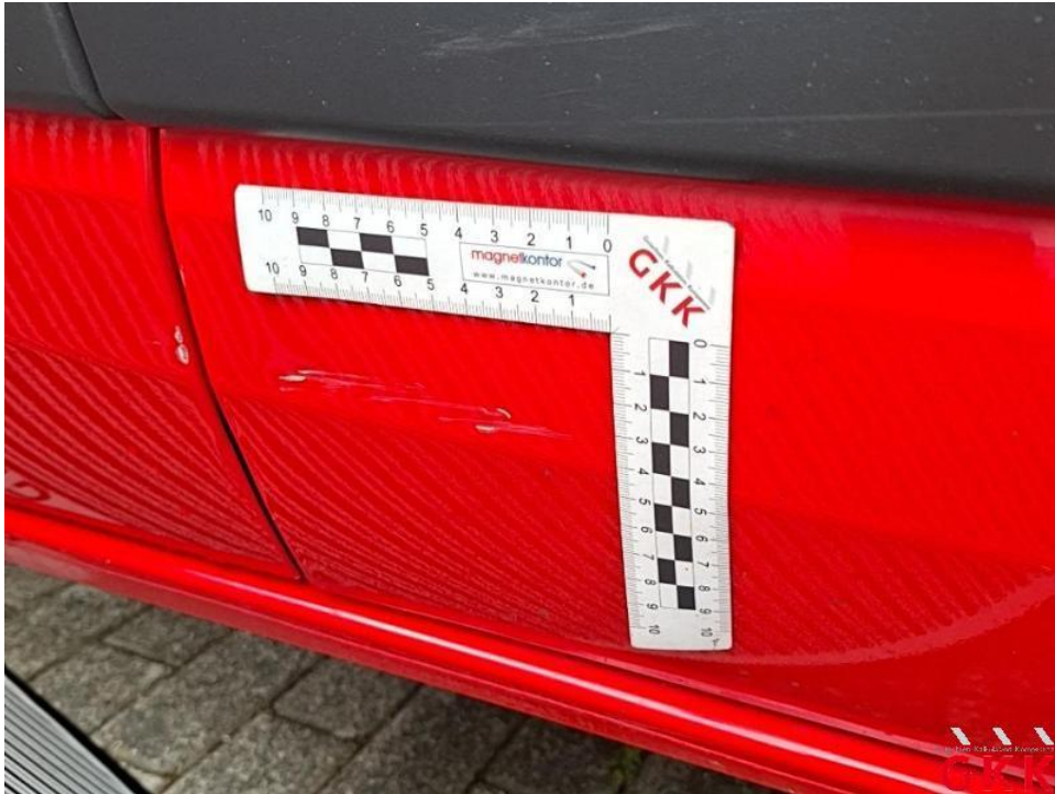
Bild 39. Tür vorne rechts, beschädigt, instand setzen - lackieren
