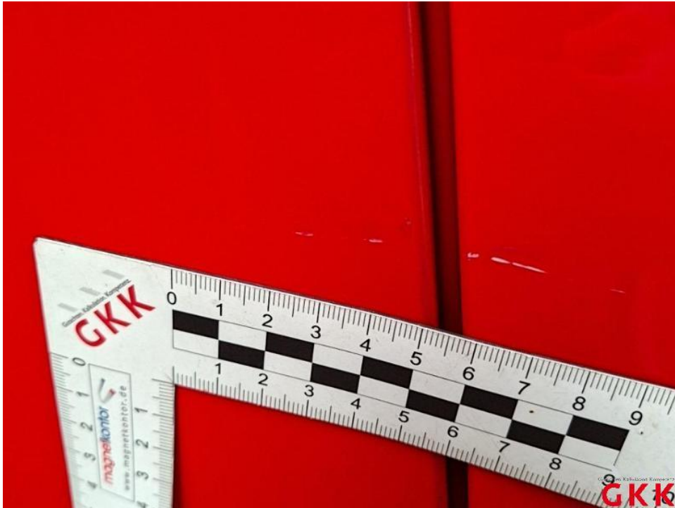
Bild 35. Seitenwand rechts, verkratzt, Smartrepair
