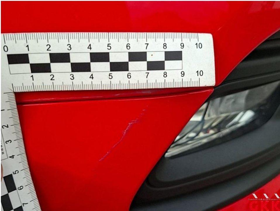
Bild 16. Stoßfänger vorne, Verkleidung unterhalb -lackiert-, verkratzt, Smartrepair
