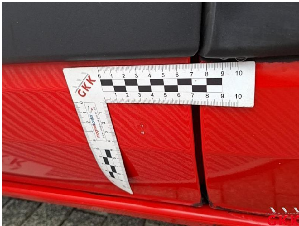
Bild 20. Tür vorne links, beschädigt, instand setzen - lackieren
