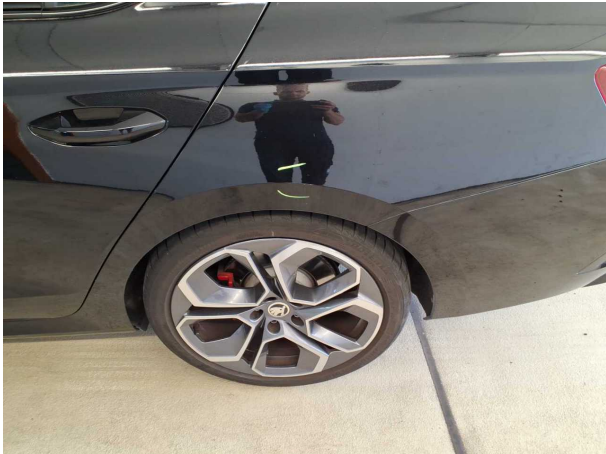
Beschädigung #1: Seitenwand links: Seitenwand - verkratzt / verschürft - auslegen / polieren
