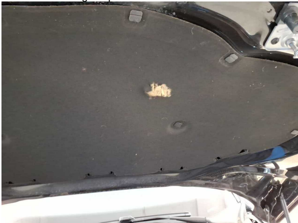
Beschädigung #3: Motorhaube: Dämmmatte - Marderschaden - erneuern
