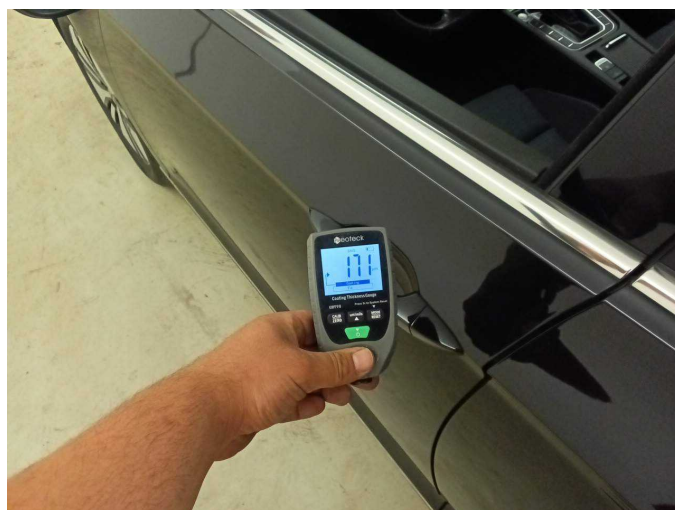
Door - front left side: 171 µm
