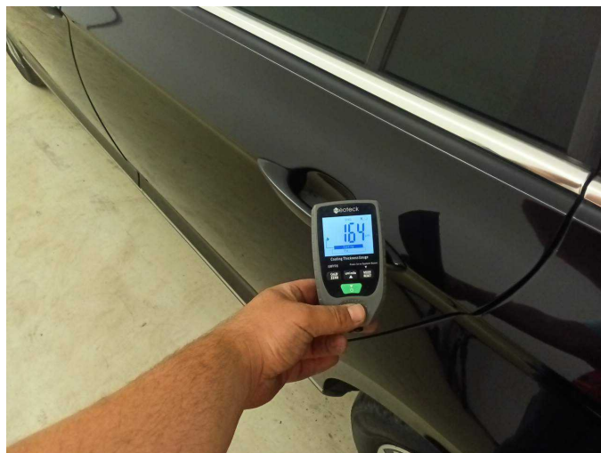
Door - rear left side: 164 µm
