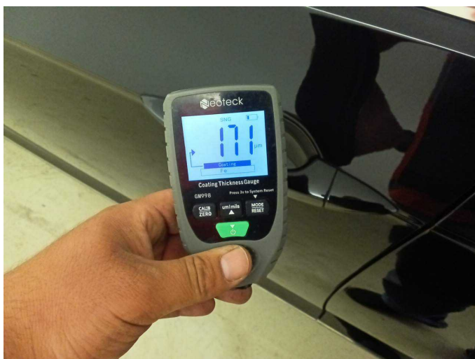
Door - front left side: 171 µm
