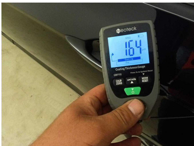
Door - rear left side: 164 µm
