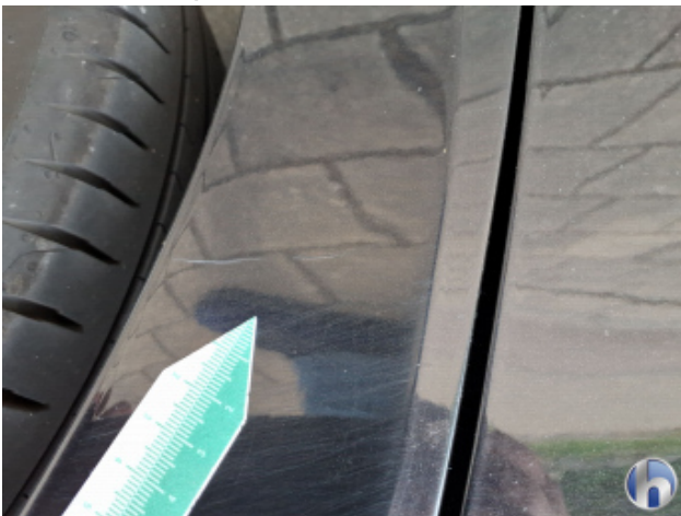
4. Seitenwand - Hinten - Links Kratzer - Smart Repair
