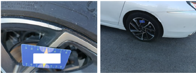
Bumper Achter - Bumper achter - Deuk - Vervangen en spuiten
