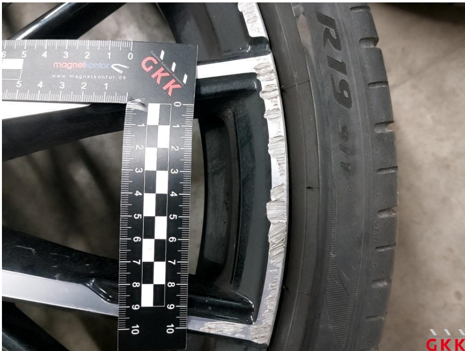
Bild 20 LM-Rad, 1 x beiliegend, beschädigt, ersetzen
