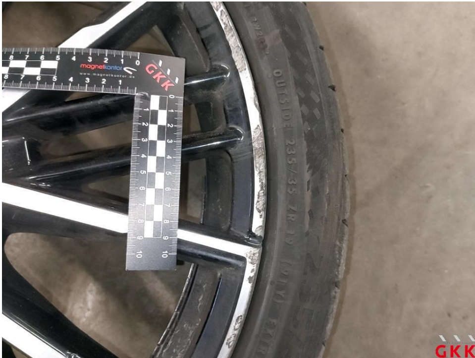
Bild 17 LM-Rad, 1 x beiliegend, beschädigt, ersetzen
