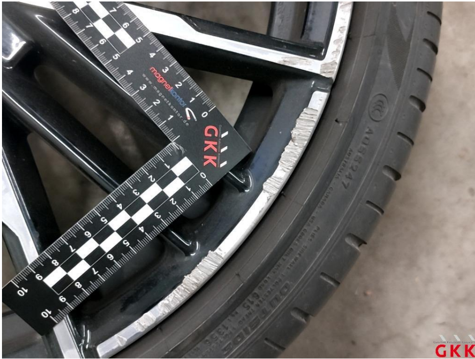
Bild 21 LM-Rad, 1 x beiliegend, beschädigt, ersetzen
