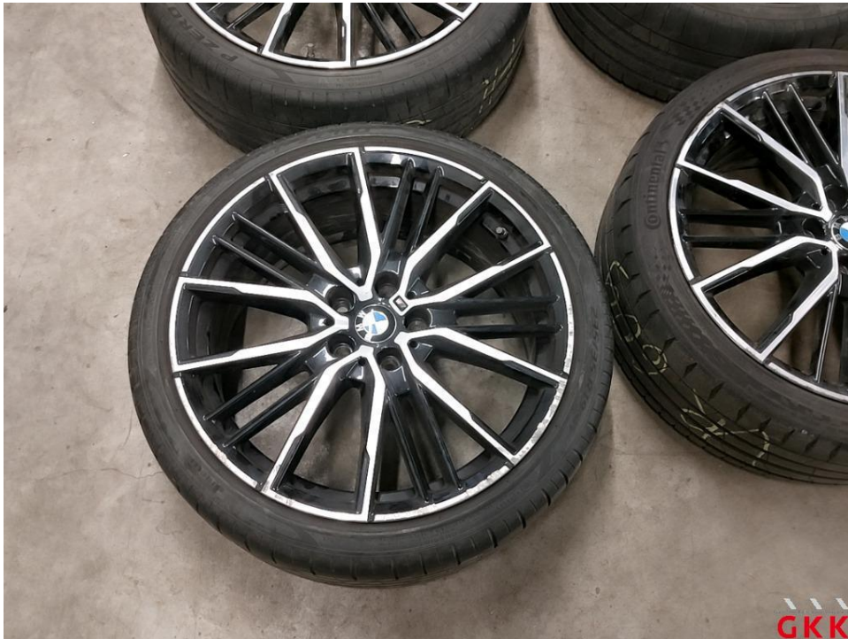
Bild 19 LM-Rad, 1 x beiliegend, beschädigt, ersetzen
