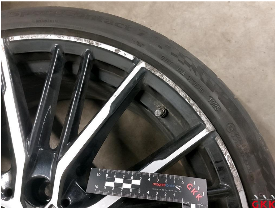
Bild 18 LM-Rad, 1 x beiliegend, beschädigt, ersetzen
