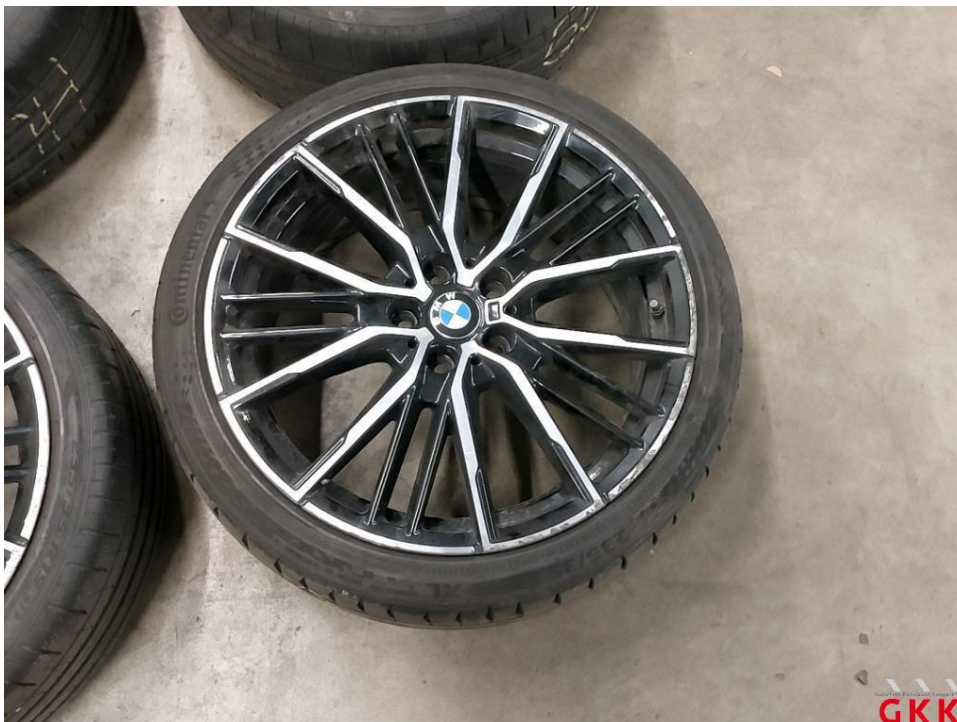
Bild 16 LM-Rad, 1 x beiliegend, beschädigt, ersetzen
