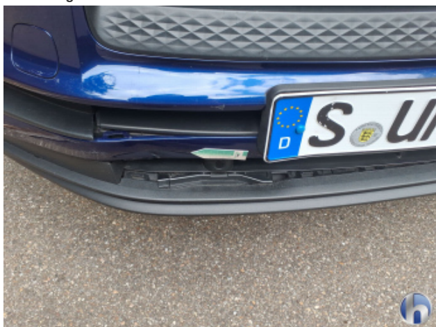
1. Stoßfänger Vorne Beschädigt - Erneuern
