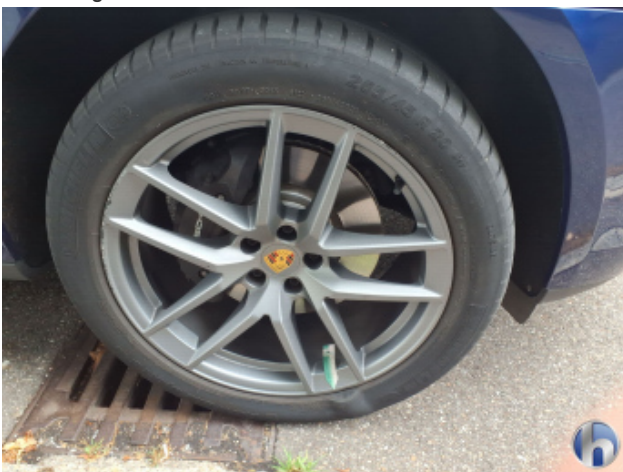
12. Reifen Vorne - Rechts Beschädigt - Erneuern
