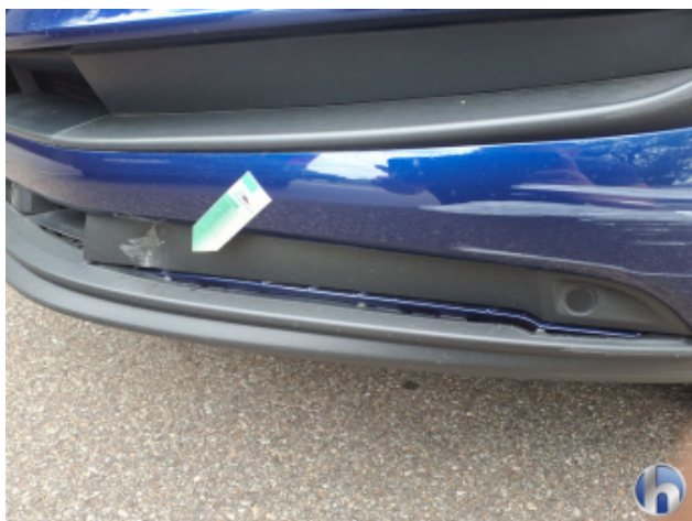
1. Stoßfänger Vorne Beschädigt - Erneuern
