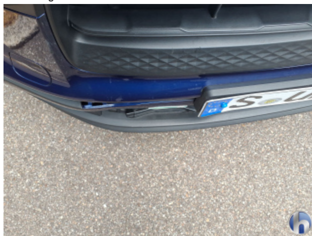
1. Stoßfänger Vorne Beschädigt - Erneuern
