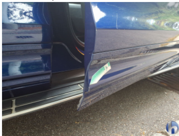
6. Tür Vorne - Rechts Kratzer - Smart Repair
