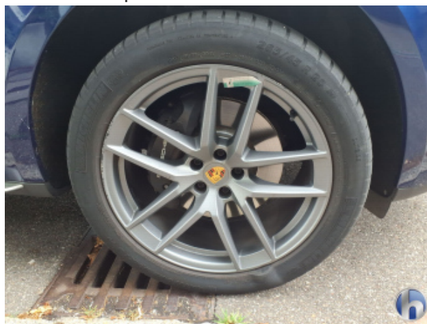
5. Felge Vorne - Rechts Kratzer - Smart Repair
