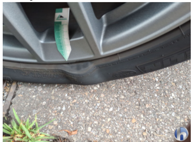
12. Reifen Vorne - Rechts Beschädigt - Erneuern
