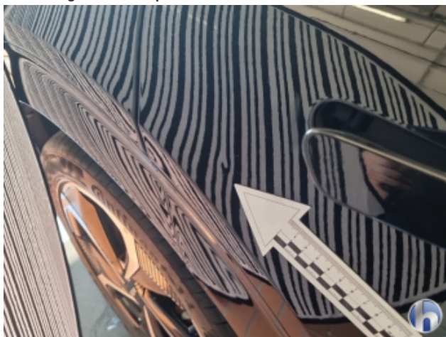
4. Tür Hinten - Rechts 1 Delle - Sanft Instandsetzen
