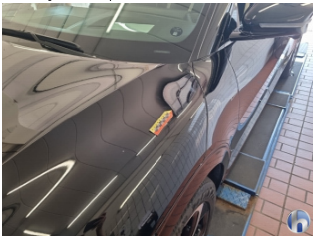
2. Motorhaube Harz-/ Säureeinwirkung - Smart Repair
