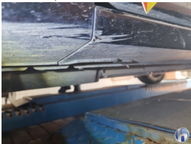
6. Schweller - Links Beschädigt - Smart Repair
