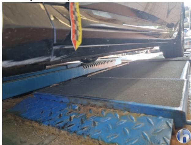
6. Schweller - Links Beschädigt - Smart Repair
