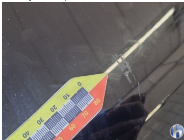
2. Motorhaube Harz-/ Säureeinwirkung - Smart Repair
