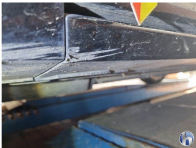
6. Schweller - Links Beschädigt - Smart Repair
