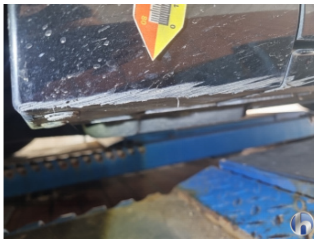
6. Schweller - Links Beschädigt - Smart Repair
