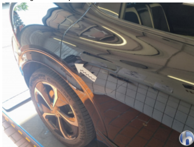
4. Tür Hinten - Rechts 1 Delle - Sanft Instandsetzen
