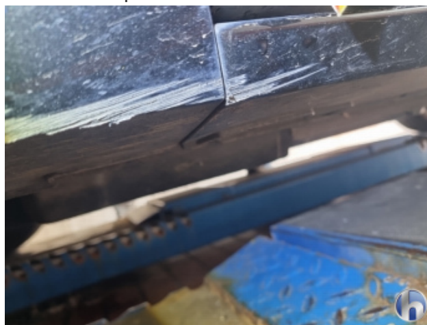
6. Schweller - Links Beschädigt - Smart Repair
