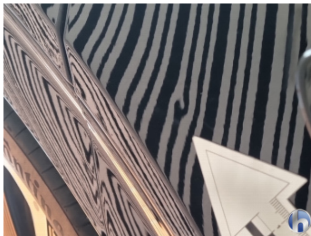
4. Tür Hinten - Rechts 1 Delle - Sanft Instandsetzen
