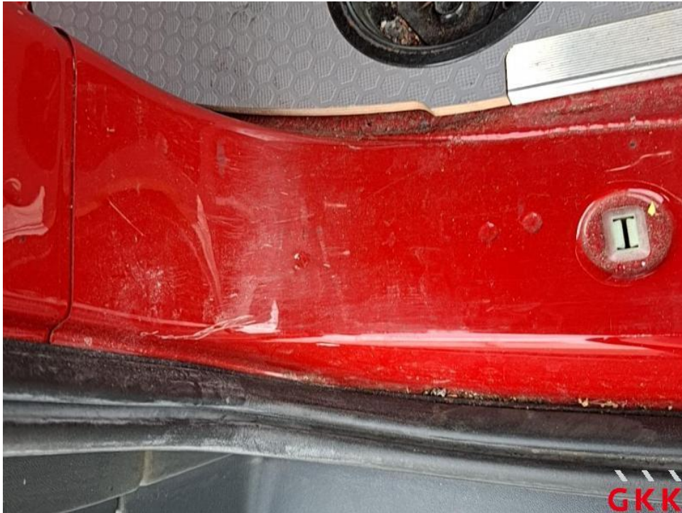
Bild 23. Ladekante, verkratzt, lackieren
