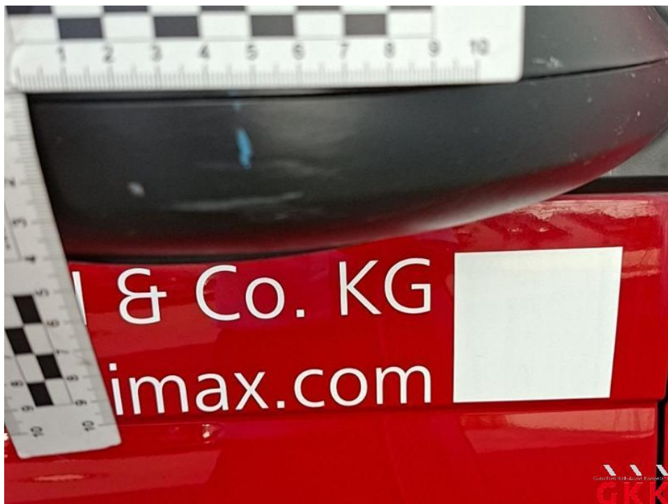
Bild 46. Spiegelgehäuse rechts, Blende -unlackiert-, verkratzt, ersetzen
