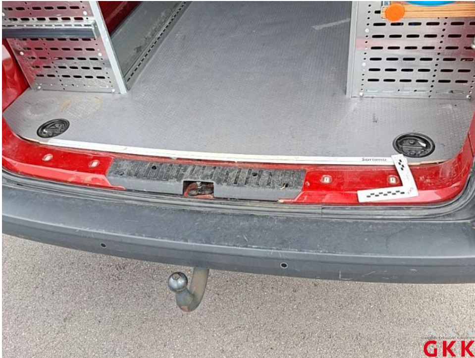
Bild 21. Ladekante, verkratzt, lackieren
