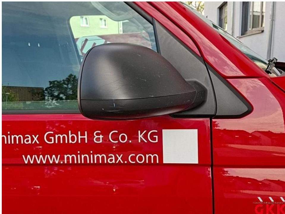
Bild 45. Spiegelgehäuse rechts, Blende -unlackiert-, verkratzt, ersetzen
