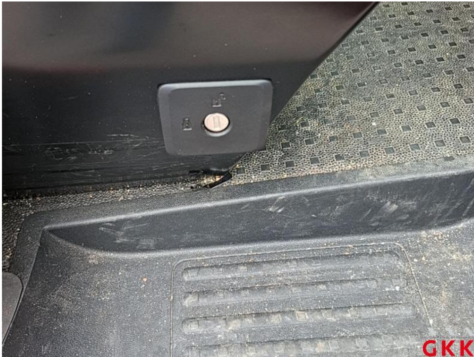
Bild 38. 2x Schlüssel für Sitzbank rechts Verriegelung, fehlt, ersetzen
