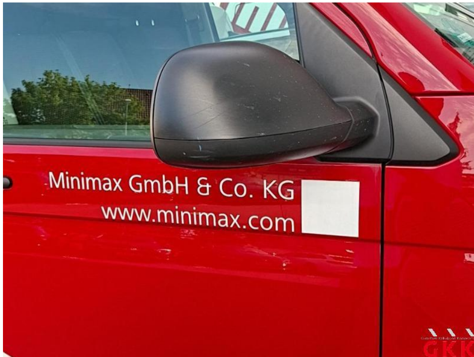
Bild 47. Spiegelgehäuse rechts, Kappe -unlackiert-, verkratzt, ersetzen
