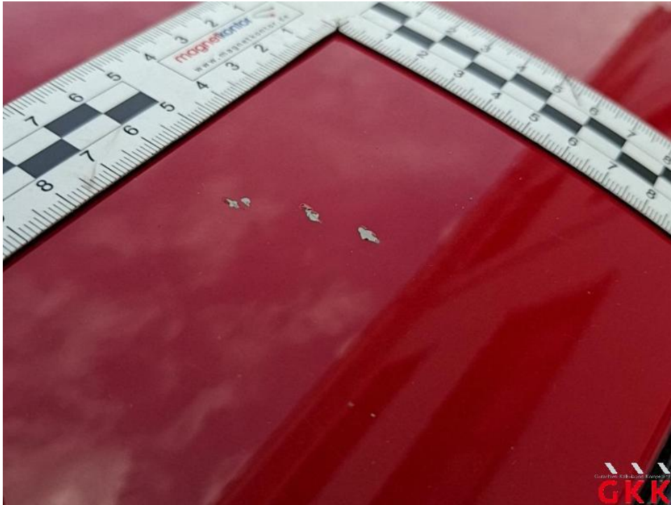
Bild 41. Dach, beschädigt, instand setzen - lackieren
