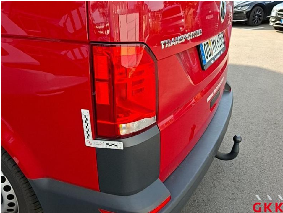
Bild 61. Rückleuchte links, außen, verkratzt, ersetzen
