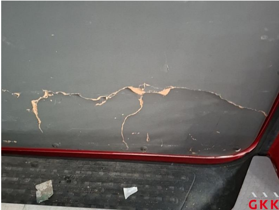
Bild 15. Schiebetür rechts, Innenverkleidung, beschädigt, ersetzen
