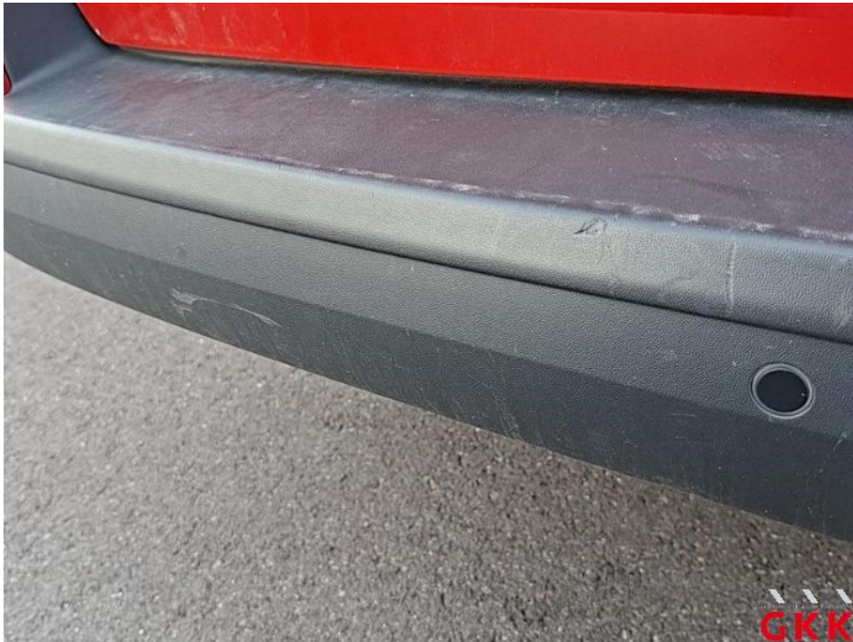
Bild 68. Stoßfänger hinten, Verkleidung -unlackiert-, beschädigt, ersetzen
