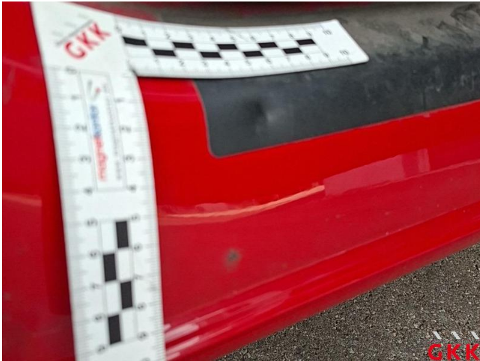
Bild 36. Tür vorne rechts, Einstieg, beschädigt, instand setzen - lackieren
