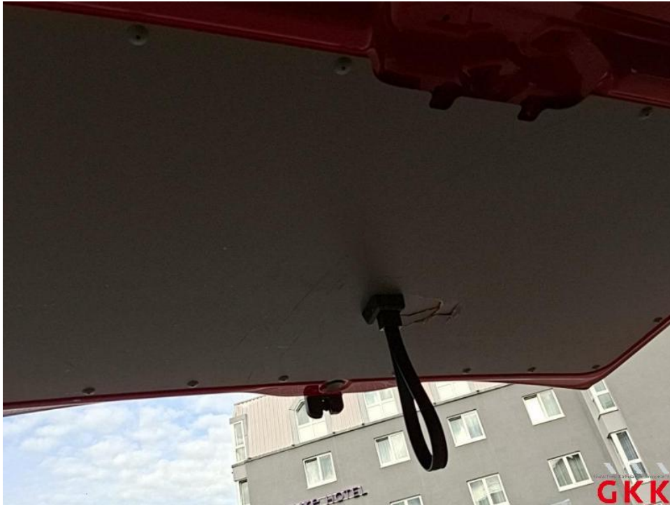
Bild 27. Heckklappe, Innenverkleidung, beschädigt, ersetzen
