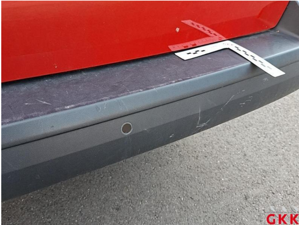
Bild 67. Stoßfänger hinten, Verkleidung -unlackiert-, beschädigt, ersetzen
