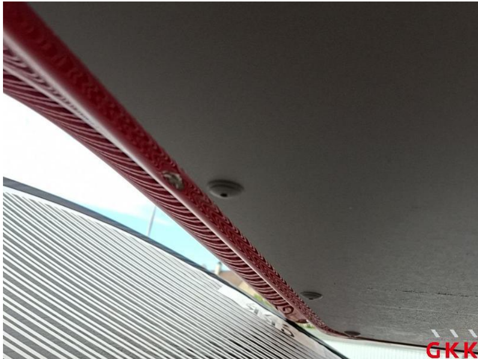
Bild 26. Heckklappe, innen, beschädigt, instand setzen - lackieren
