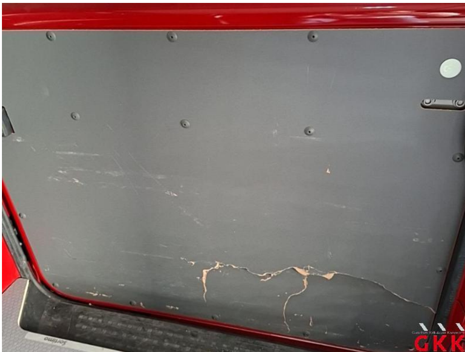
Bild 14. Schiebetür rechts, Innenverkleidung, beschädigt, ersetzen
