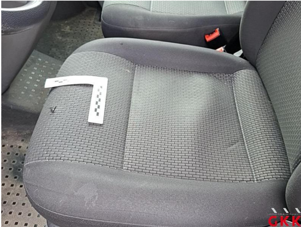
Bild 29. Sitz vorne links, Bezug Sitzkissen -Stoff-, beschädigt, ersetzen
