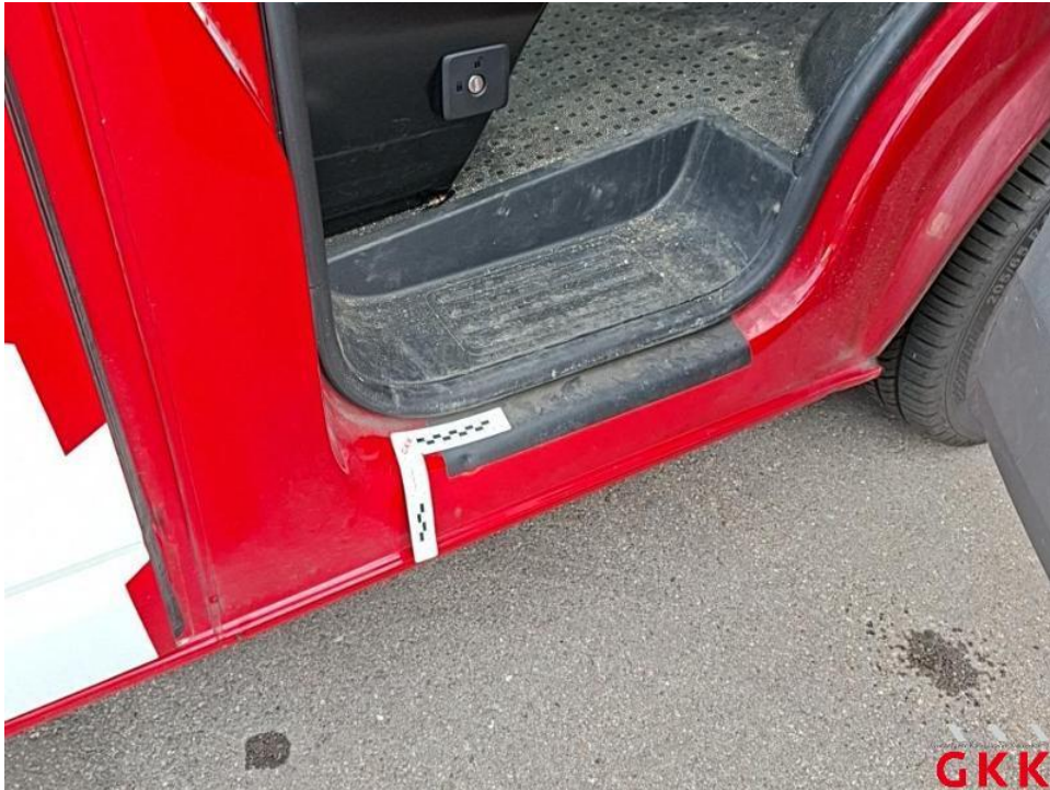
Bild 35. Tür vorne rechts, Einstieg, beschädigt, instand setzen - lackieren
