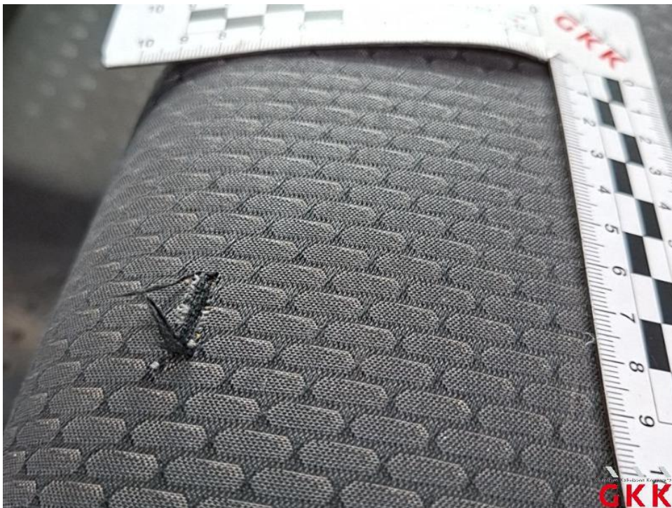
Bild 30. Sitz vorne links, Bezug Sitzkissen -Stoff-, beschädigt, ersetzen
