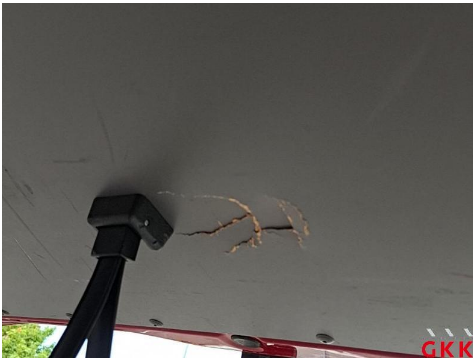
Bild 28. Heckklappe, Innenverkleidung, beschädigt, ersetzen
