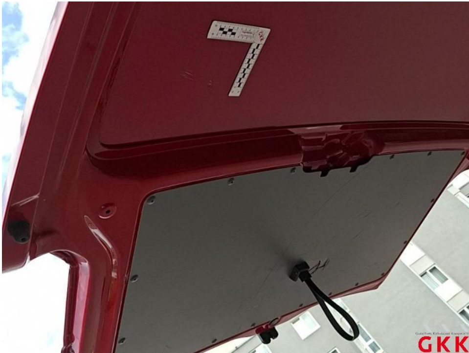
Bild 24. Heckklappe, innen, beschädigt, instand setzen - lackieren
