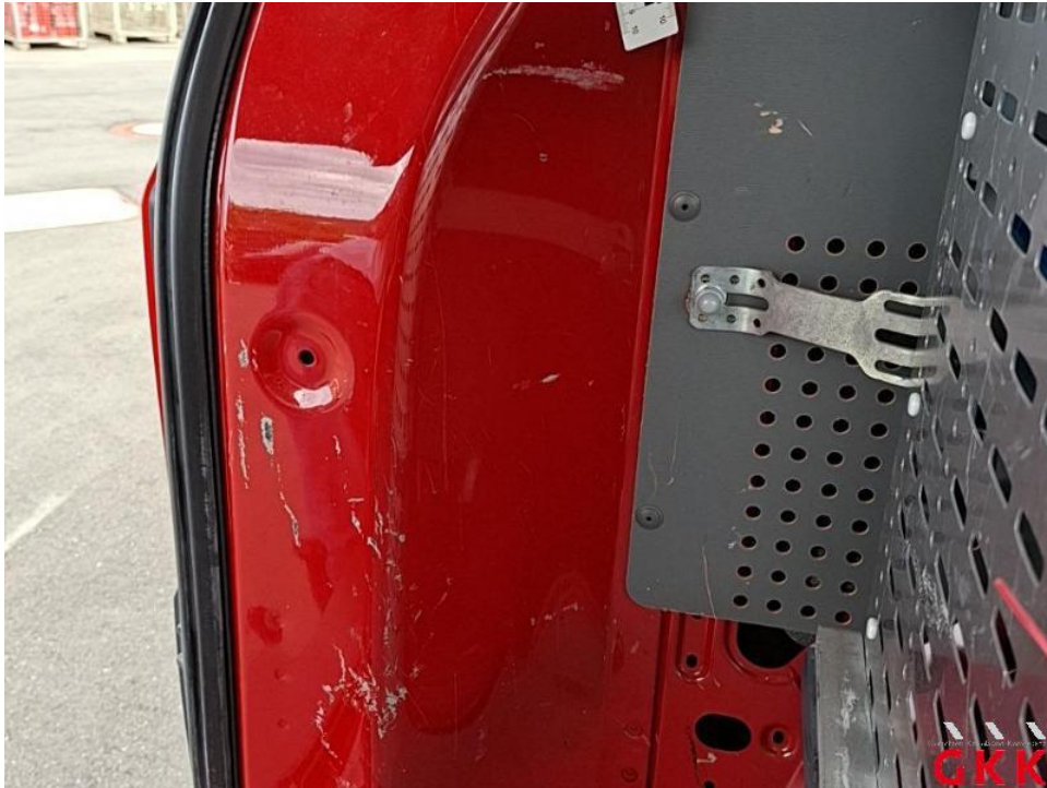
Bild 17. D- Säule links, verkratzt, lackieren
