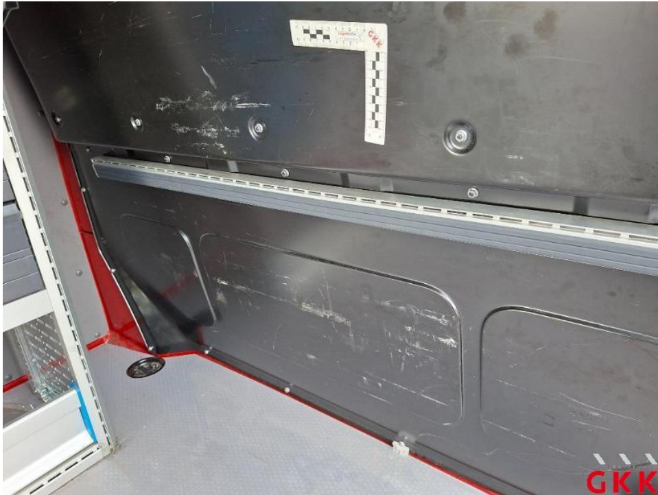
Bild 13. Trennwand, verkratzt, Spotlackieren
