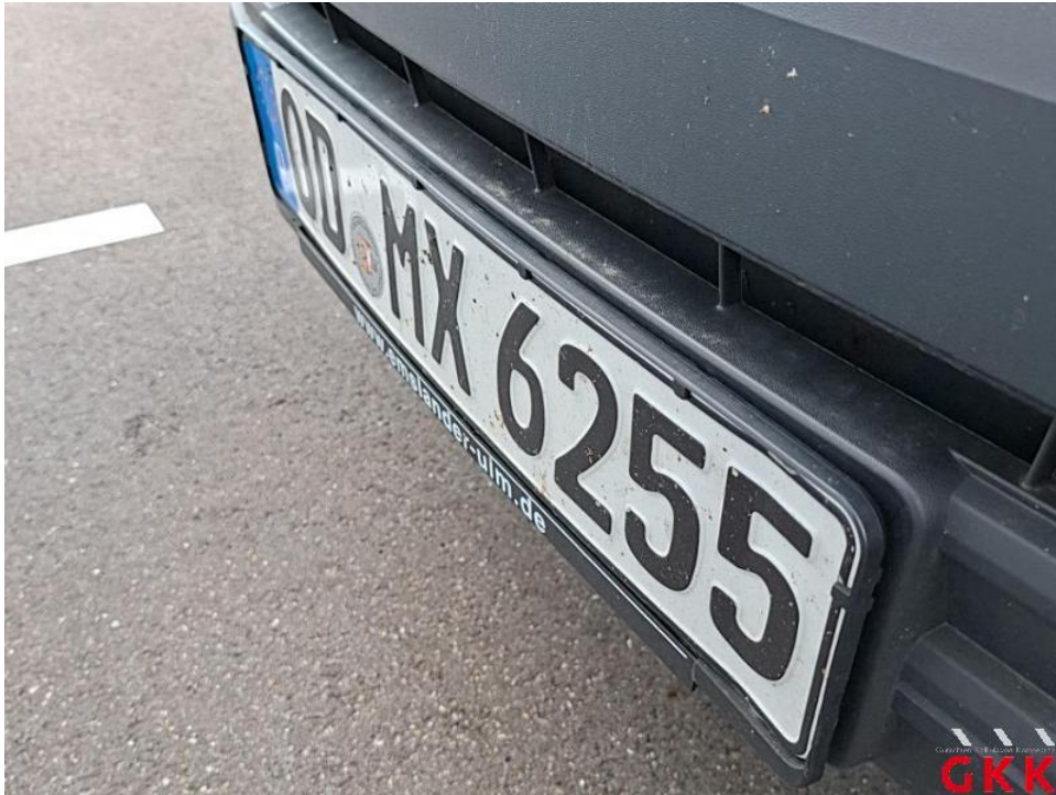
Bild 51. Kennzeichen vorne, beschädigt, ersetzen
