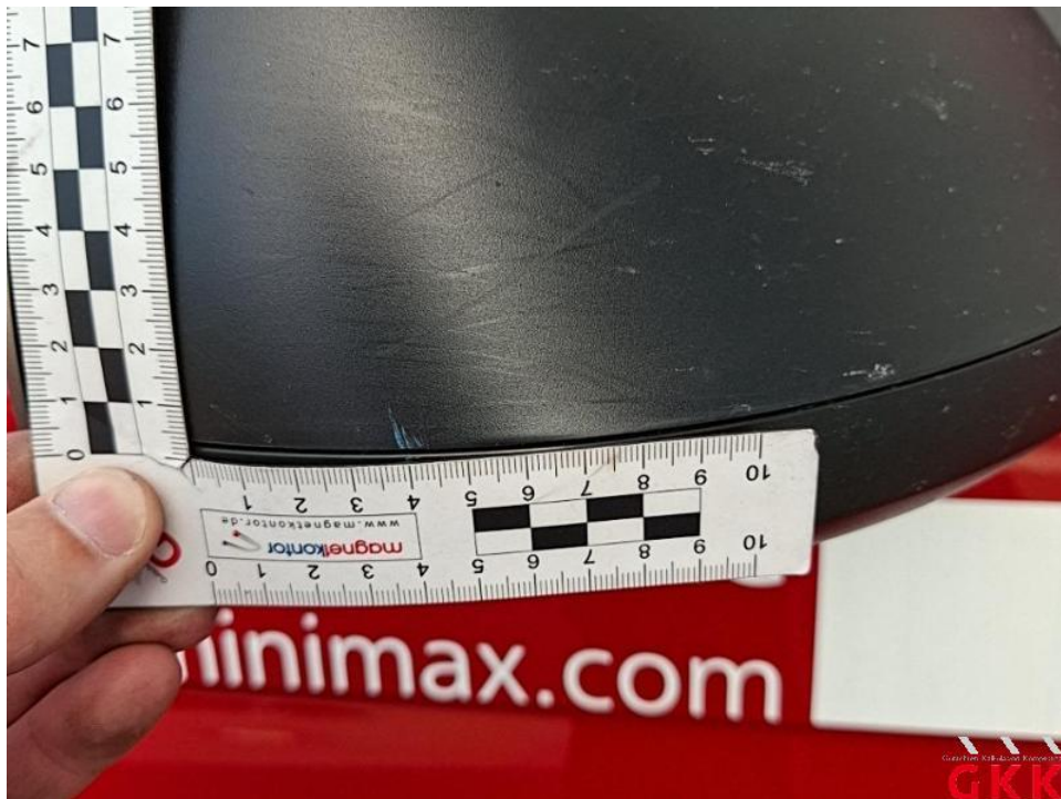
Bild 48. Spiegelgehäuse rechts, Kappe -unlackiert-, verkratzt, ersetzen
