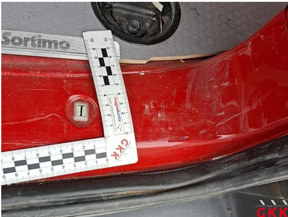
Bild 22. Ladekante, verkratzt, lackieren
