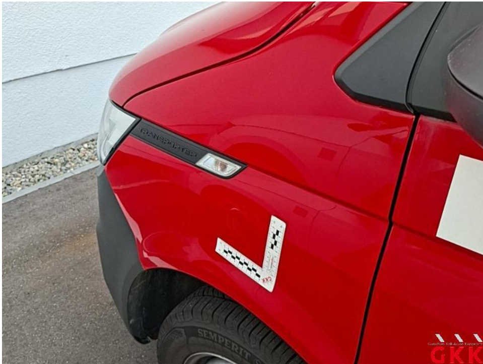
Bild 52. Kotflügel vorne links, beschädigt, instand setzen - lackieren
