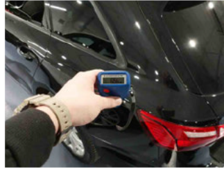
Lackstärke Seitenwand hinten links
