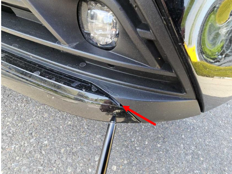
Halterabbruch an Spoiler.
