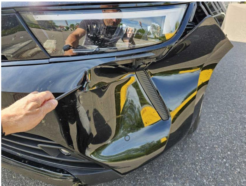
Deformation durch Anstoß von weichen Körper erfolgt.
