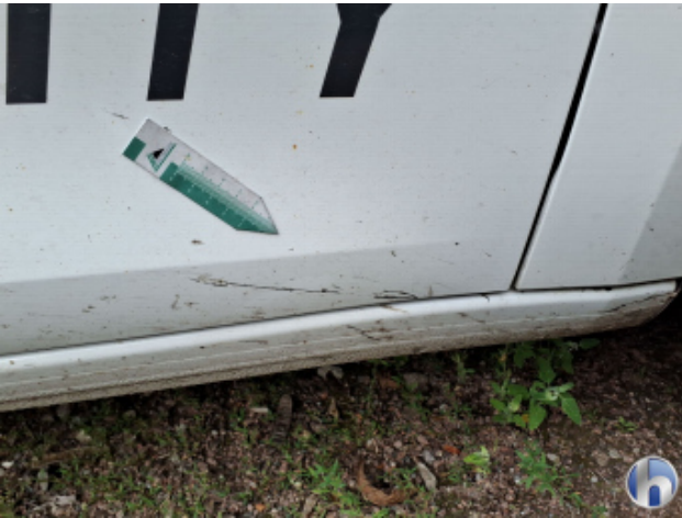
4. Tür Vorne - Rechts Kratzer - Lackieren
