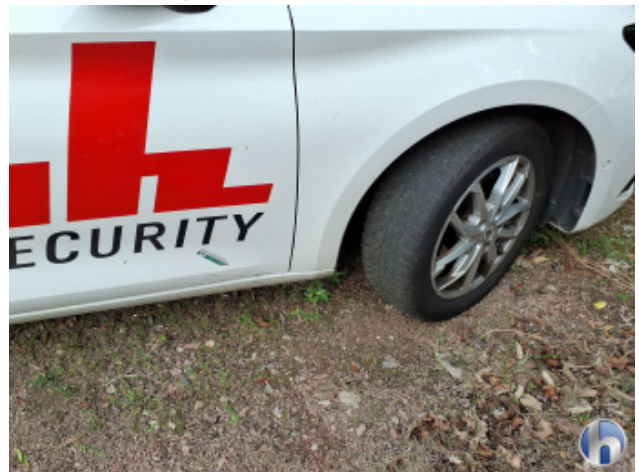
4. Tür Vorne - Rechts Kratzer - Lackieren
