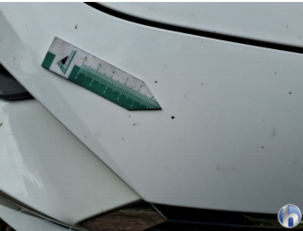
5. Stoßfänger Vorne Steinschlag - Lackieren
