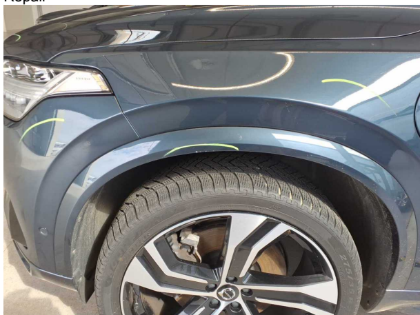
Beschädigung #4: Kotflügel links: Radhausverbreiterung - Kratzer - Smart Repair
