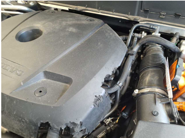
Beschädigung #5: Motor: Motorabdeckung - Marderschaden - erneuern
