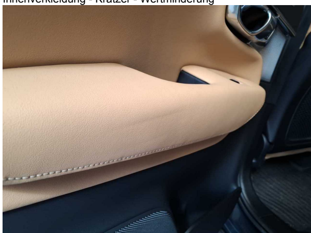
Beschädigung #2: Verkleidungen/Abdeckungen: Türverkleidung hinten links - verformt - Smart Repair
