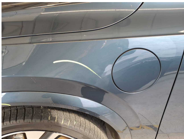
Beschädigung #3: Kotflügel links: Kotflügel links - Kratzer - Smart Repair
