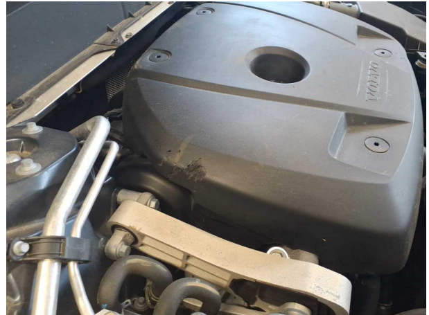
Beschädigung #5: Motor: Motorabdeckung - Marderschaden - erneuern
