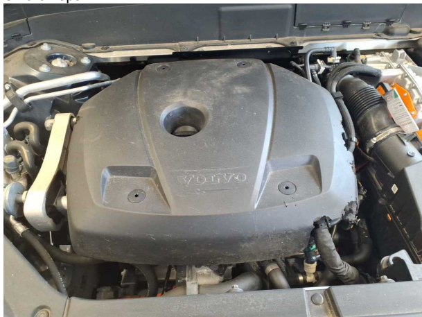
Beschädigung #5: Motor: Motorabdeckung - Marderschaden - erneuern
