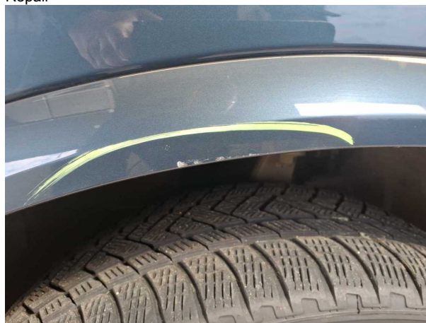
Beschädigung #4: Kotflügel links: Radhausverbreiterung - Kratzer - Smart Repair
