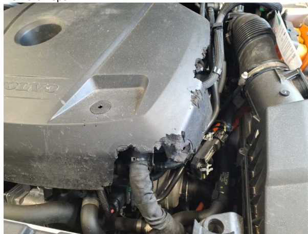
Beschädigung #5: Motor: Motorabdeckung - Marderschaden - erneuern
