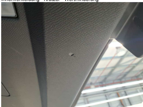
Beschädigung #1: Verkleidungen/Abdeckungen: Heckdeckel, Innenverkleidung - Kratzer - Wertminderung
