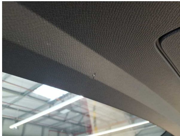
Beschädigung #1: Verkleidungen/Abdeckungen: Heckdeckel, Innenverkleidung - Kratzer - Wertminderung
