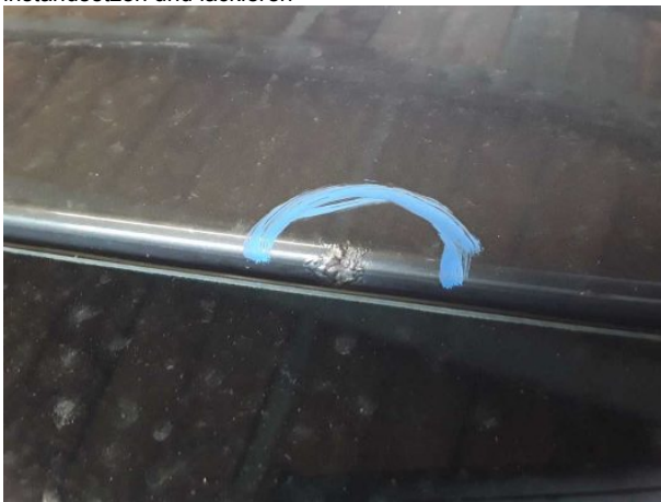
Beschädigung #10: Fahrzeugdach: Dach - Korrosion - instandsetzen und lackieren
