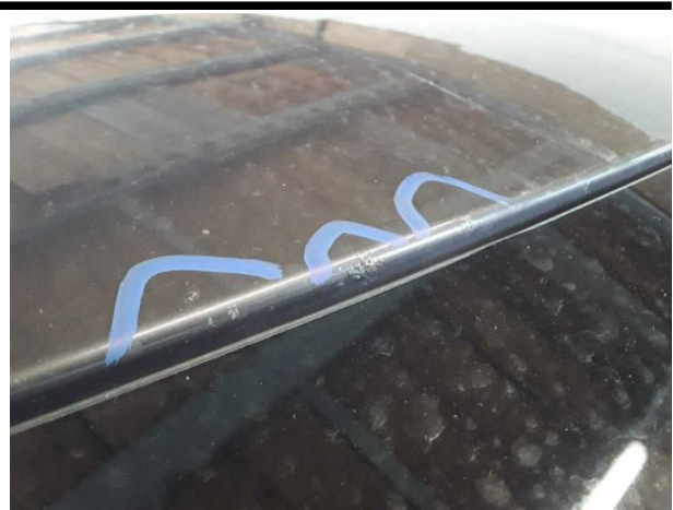
Beschädigung #10: Fahrzeugdach: Dach - Korrosion - instandsetzen und lackieren
