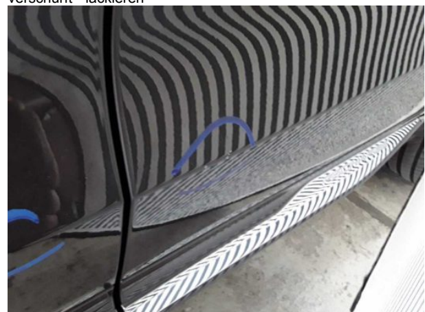
Beschädigung #7: Tür hinten links: Tür - verkratzt / verschürft... lackieren
