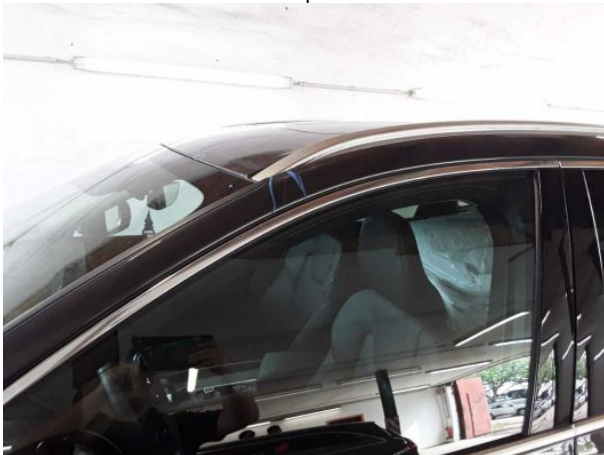
Beschädigung #6: Fahrzeugdach: Dachholm links - verkratzt / verschürft - lackieren
