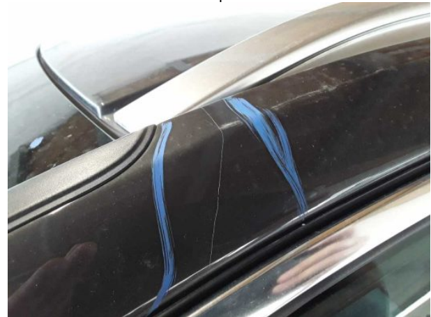
Beschädigung #6: Fahrzeugdach: Dachholm links - verkratzt / verschürft - lackieren
