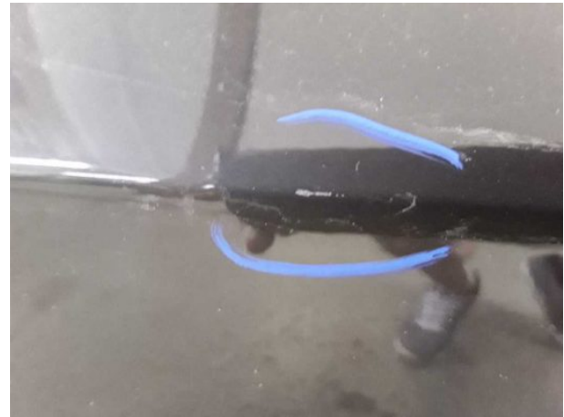
Beschädigung #8: Tür vorn links: Tür - verkratzt / verschürft - lackieren
