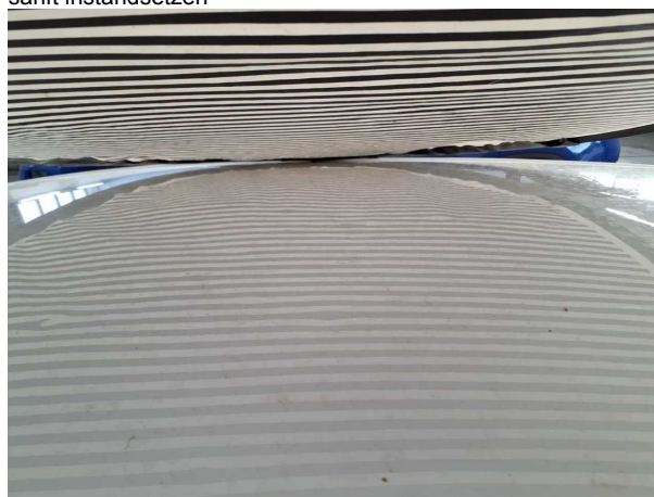
Beschädigung #6: Karosserie: Karosserie - Hagelschaden - sanft instandsetzen
