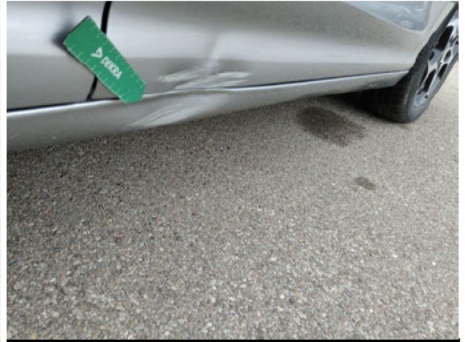
Schweller / Rechts / Delle
