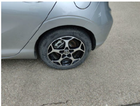
Felge / Hinten Links / Kratzer
