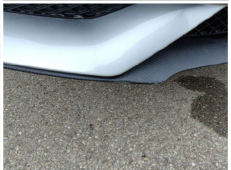
Spoiler / Vorne / Gebrochen
