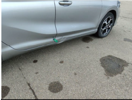
Schweller / Rechts / Delle
