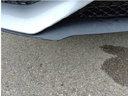
Spoiler / Vorne / Gebrochen
