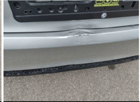
Stoßfänger / Hinten / Gebrochen
