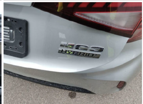
Schriftzug Heckklappe / Kofferraumtür / Rechts / Delle
