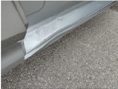
Schweller / Rechts / Delle
