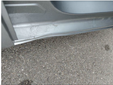
Schweller / Rechts / Delle
