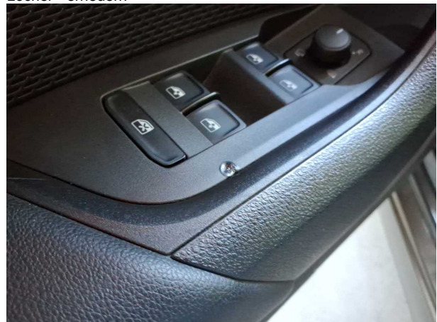
Beschädigung #2: Verkleidungen/Abdeckungen: Türverkleidung vorn links (inklusive Blende) - Brandloch -
