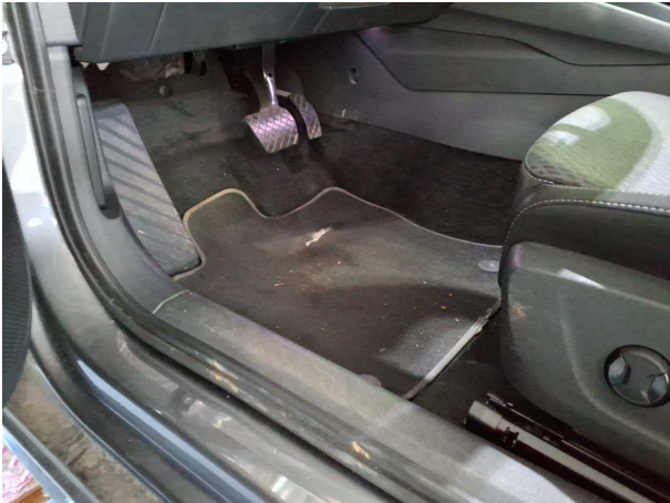
Beschädigung #1: Verkleidungen/Abdeckungen: Fußmatten - Löcher - erneuern
