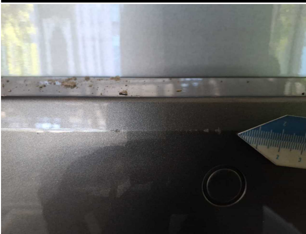
Beschädigung #9: Stossfänger hinten: Stossfänger hinten - verformt - instandsetzen und lackieren
