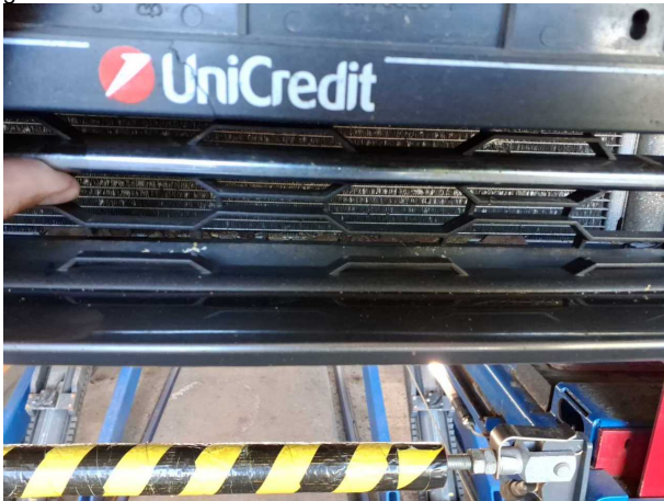
Beschädigung #8: Stoßfänger vorn: Lufteinlassgitter - gebrochen / gerissen - erneuern
