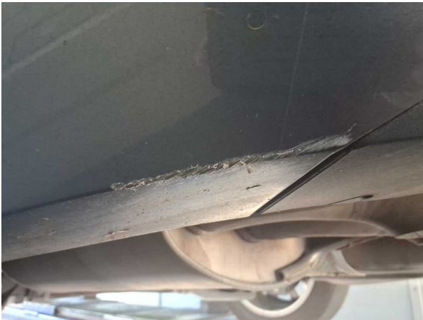
Beschädigung #9: Stossfänger hinten: Stossfänger hinten - verformt - instandsetzen und lackieren
