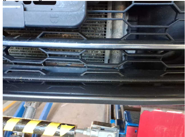
Beschädigung #8: Stoßfänger vorn: Lufteinlassgitter - gebrochen / gerissen - erneuern
