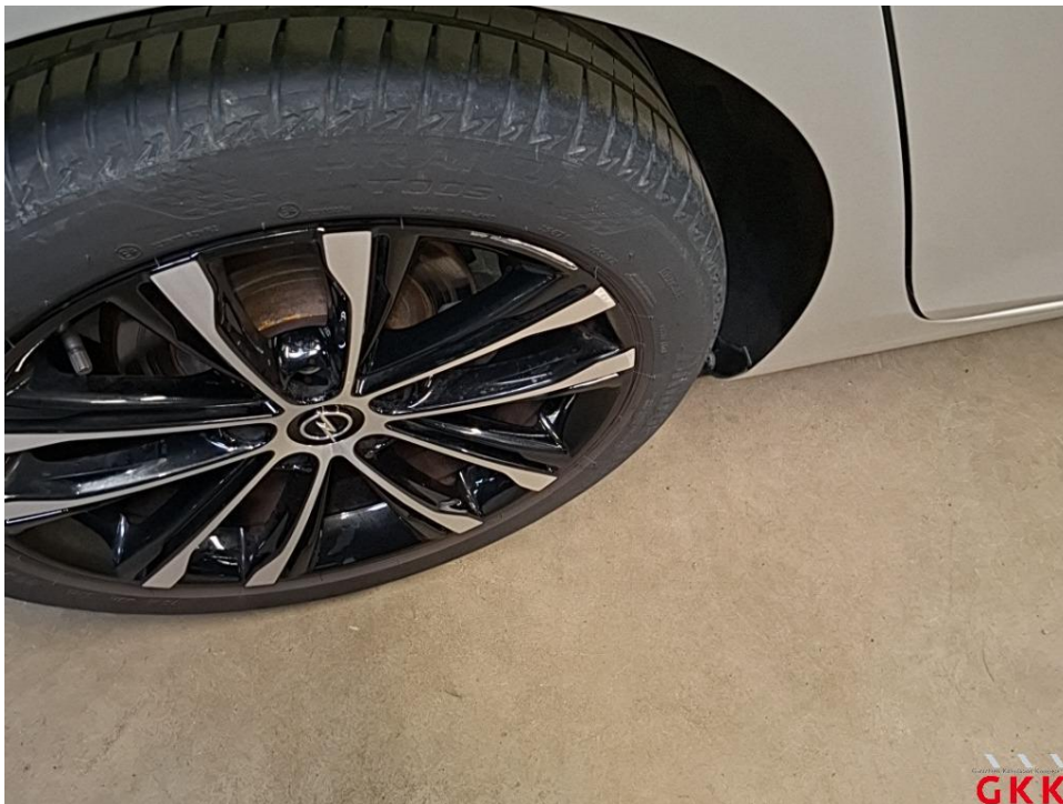
Bild 24 LM-Rad, hinten rechts, Materialabtrag, ersetzen
