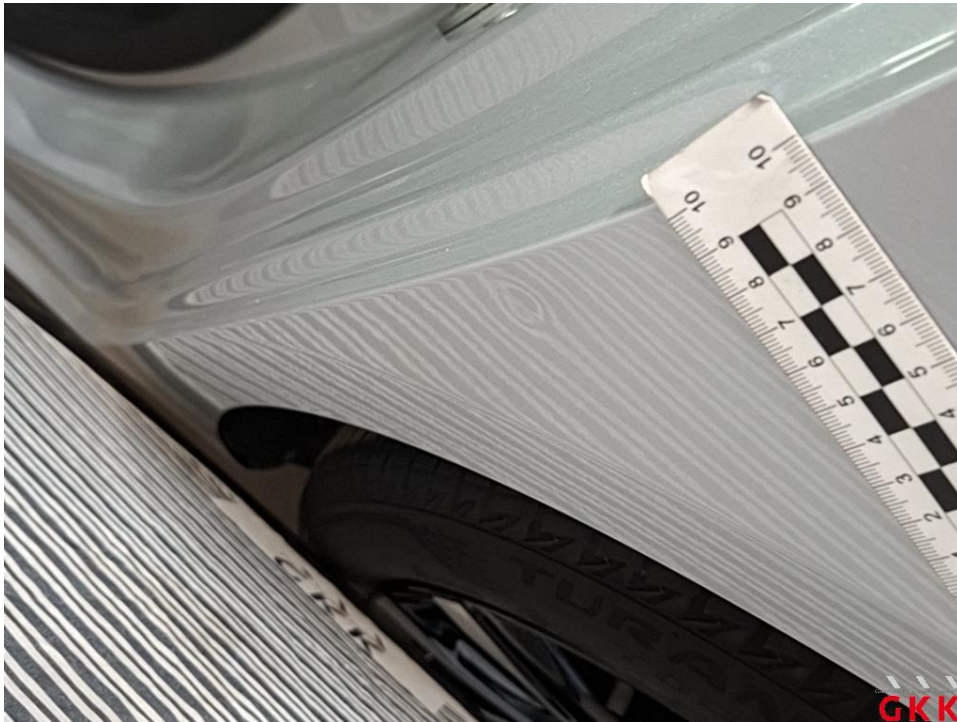
Bild 17 Seitenwand links, beschädigt, kalt drücken
