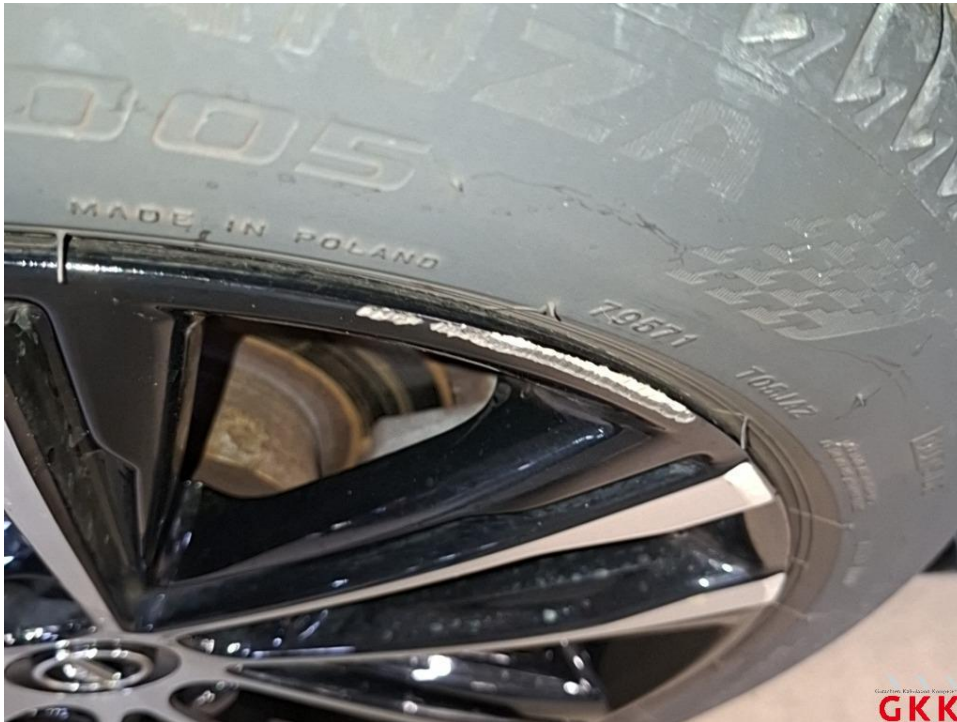
Bild 25 LM-Rad, hinten rechts, Materialabtrag, ersetzen
