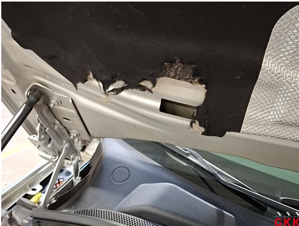
Bild 18 Motorhaube, Dämmmatte, beschädigt, ersetzen
