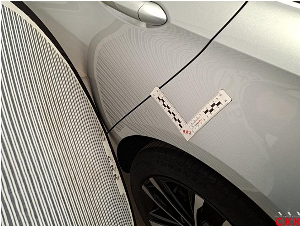
Bild 15 Seitenwand links, beschädigt, kalt drücken
