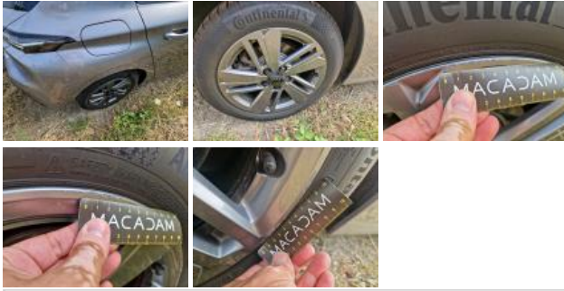
Alloy rim FR, Scratch(es), Repair/replace (lump sum)
