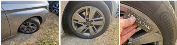
Alloy rim FL, Scratch(es), Repair/replace (lump sum)
