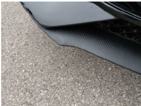
Spoiler / Vorne / Gebrochen
