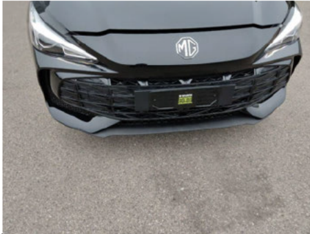
Spoiler / Vorne / Gebrochen
