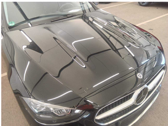
Damage 7: Bonnet: Bonnet (Übermäßige Steinschläge) - Stone chips - Paint
