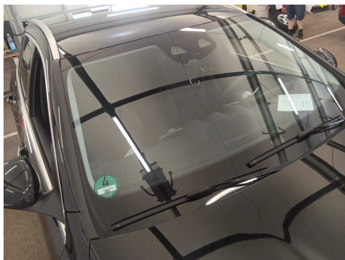
Damage 8: Vehicle glazing: Windscreen (Mit Rissbildung) - Stone chips - Replace
