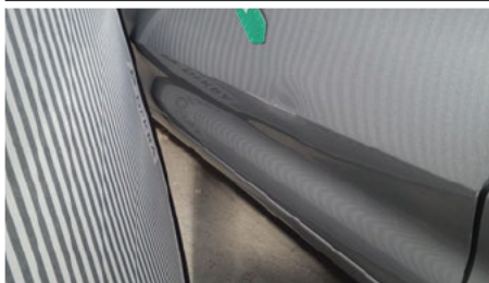
Tür / Vorne Links / Delle
