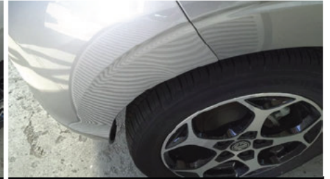
Stoßfänger / Hinten / Delle
