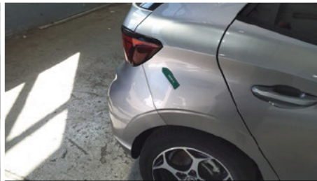
Kotflügel / Hinten Rechts / Schlecht Repariert
