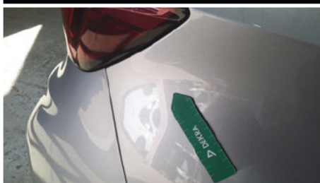
Kotflügel / Hinten Rechts / Schlecht Repariert
