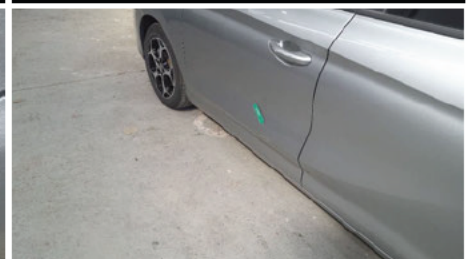
Tür / Vorne Links / Delle
