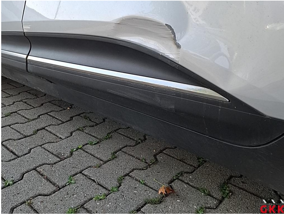
Bild 39. Tür hinten links, Leiste unten -unlackiert-, beschädigt, ersetzen
