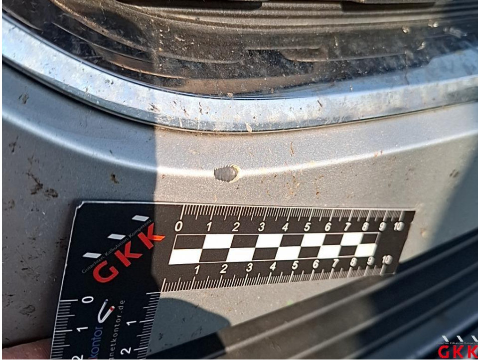
Bild 15. Stoßfänger vorne, Verkleidung -lackiert-, beschädigt, Smartrepair
