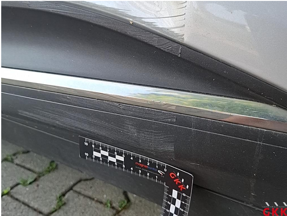
Bild 40. Tür hinten links, Leiste unten -unlackiert-, beschädigt, ersetzen
