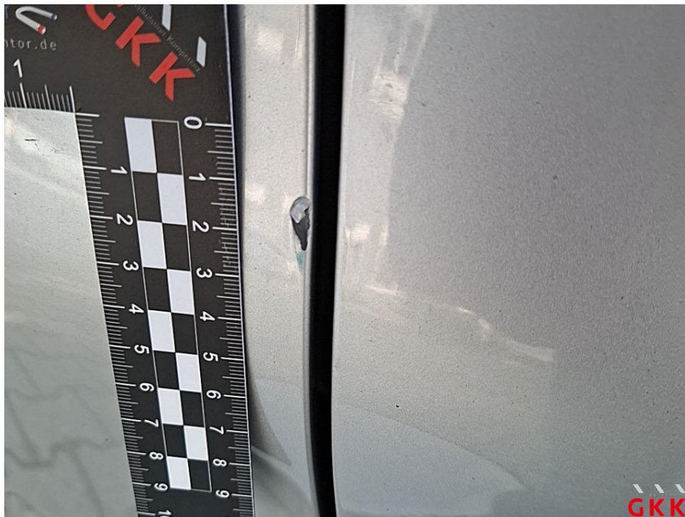
Bild 28. Stoßfänger hinten, Verkleidung oberhalb -lackiert-, beschädigt, ersetzen
