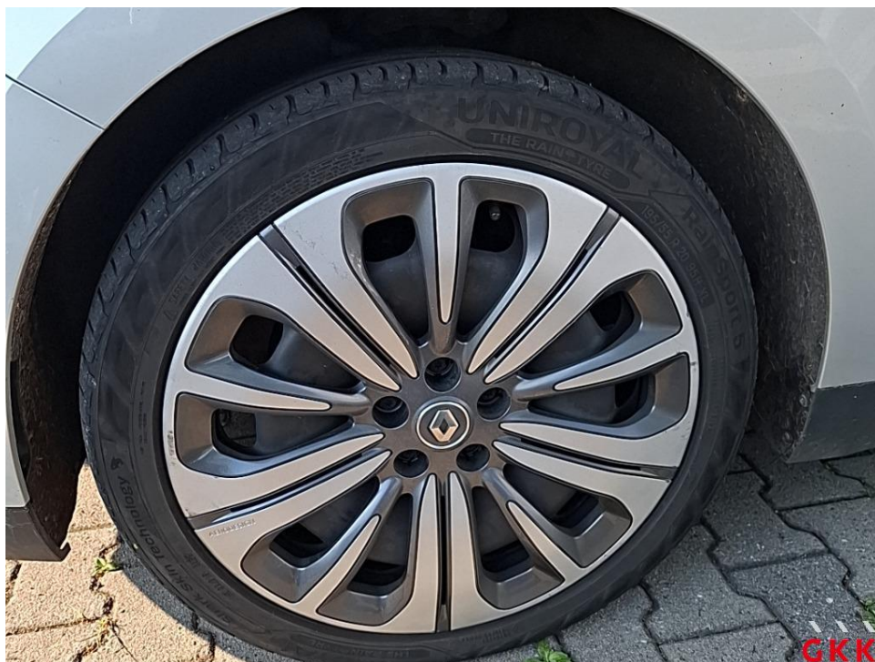
Bild 12. Reifen, vorn links und rechts, Untermaß, ersetzen
