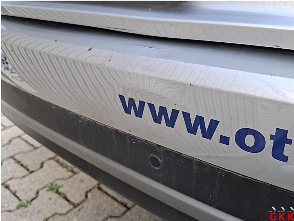
Bild 29. Stoßfänger hinten, Verkleidung oberhalb -lackiert-, beschädigt, ersetzen
