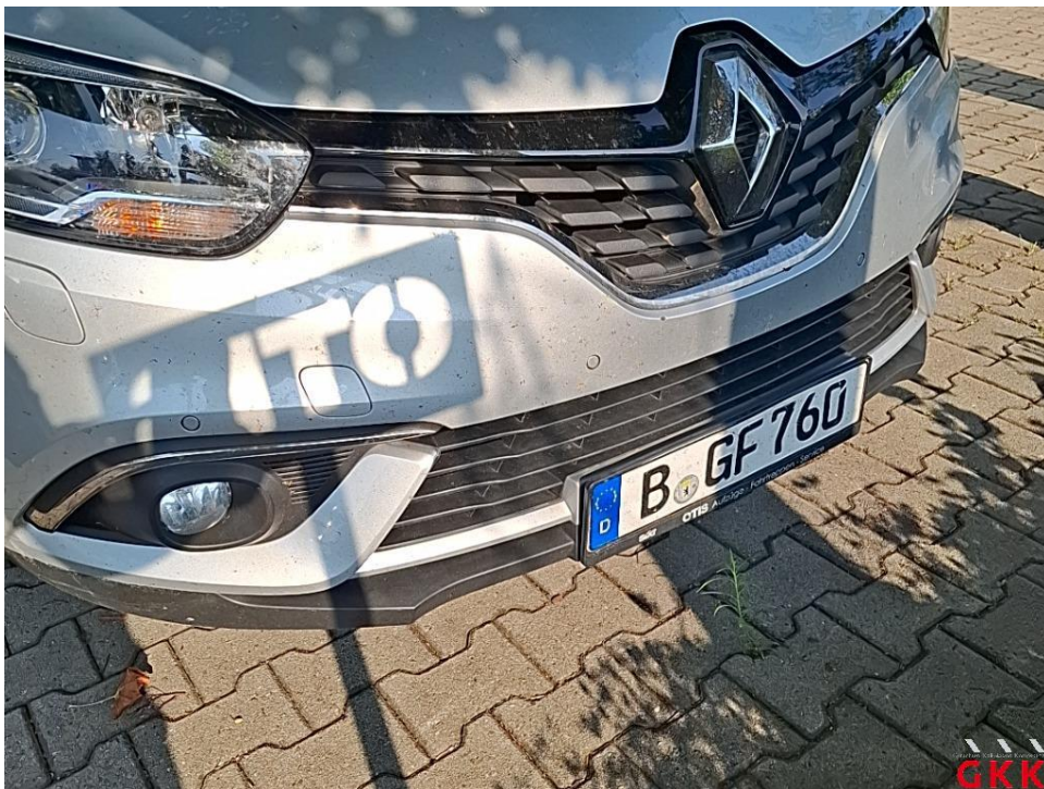
Bild 14. Stoßfänger vorne, Verkleidung -lackiert-, beschädigt, Smartrepair
