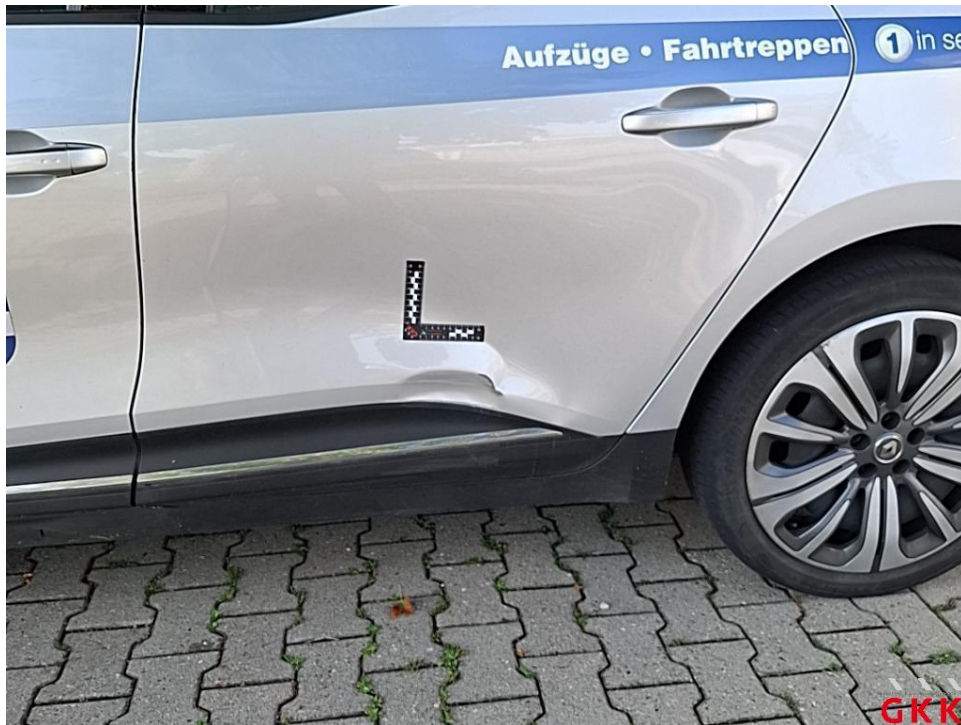
Bild 37. Tür hinten links, beschädigt, ersetzen
