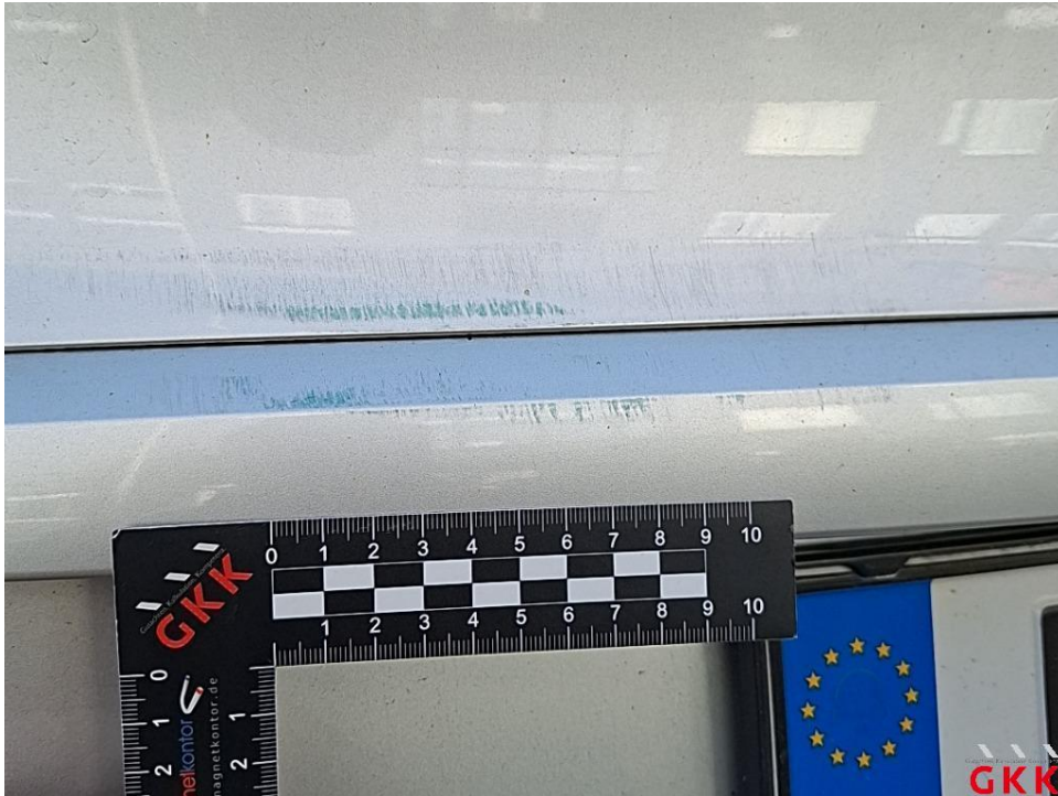
Bild 31. Heckklappe, Blende -lackiert-, verkratzt, lackieren
