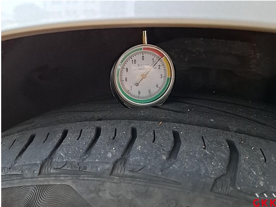
Bild 13. Reifen, vorn links und rechts, Untermaß, ersetzen
