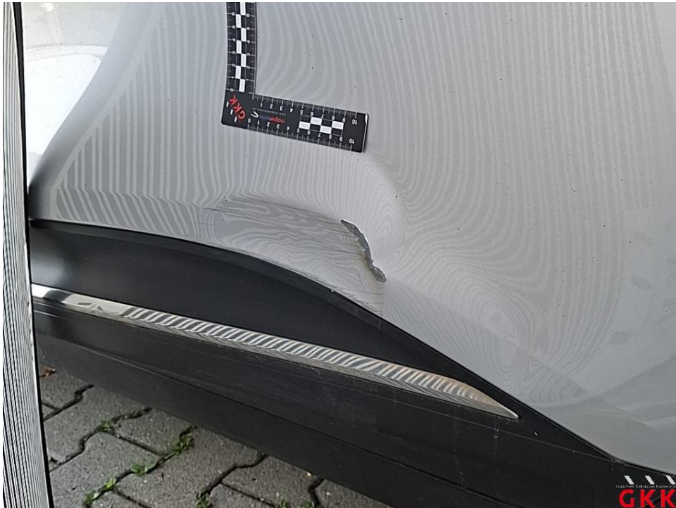
Bild 38. Tür hinten links, beschädigt, ersetzen
