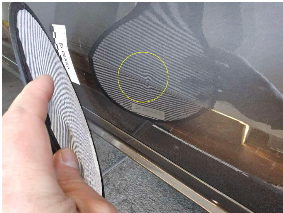
Bild 13 : Tür vorne rechts, eingedellt, instandsetzen und lackieren mit Lackaufbau
