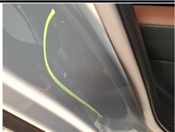
Beschädigung #7: Seitenwand rechts: Einstieg - verkratzt / verschürft - Smart Repair
