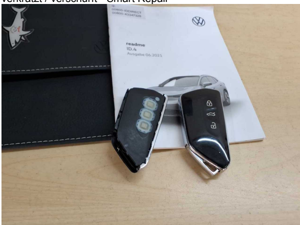
Beschädigung #10: Ausrüstung: Fahrzeugschlüssel m. Fernb. - beschädigt - erneuern
