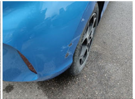
Stoßfänger / Hinten / Delle
