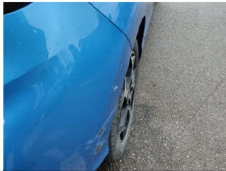
Stoßfänger / Hinten / Delle
