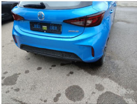
Stoßfänger / Hinten / Delle
