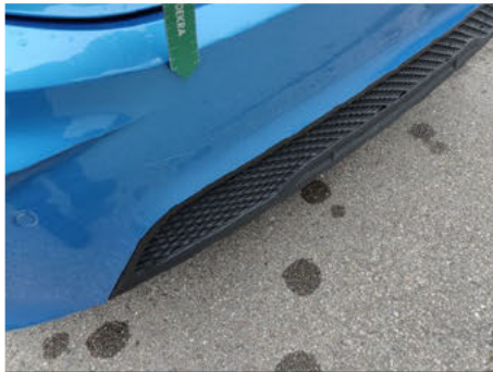
Stoßfänger / Hinten / Delle
