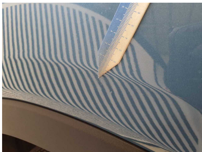
Damage 3: Side panel - rear right side: Side panel (Spachtelmasse eingefallen und Einschluss) - Unprofessionally repaired - Repair and paint
