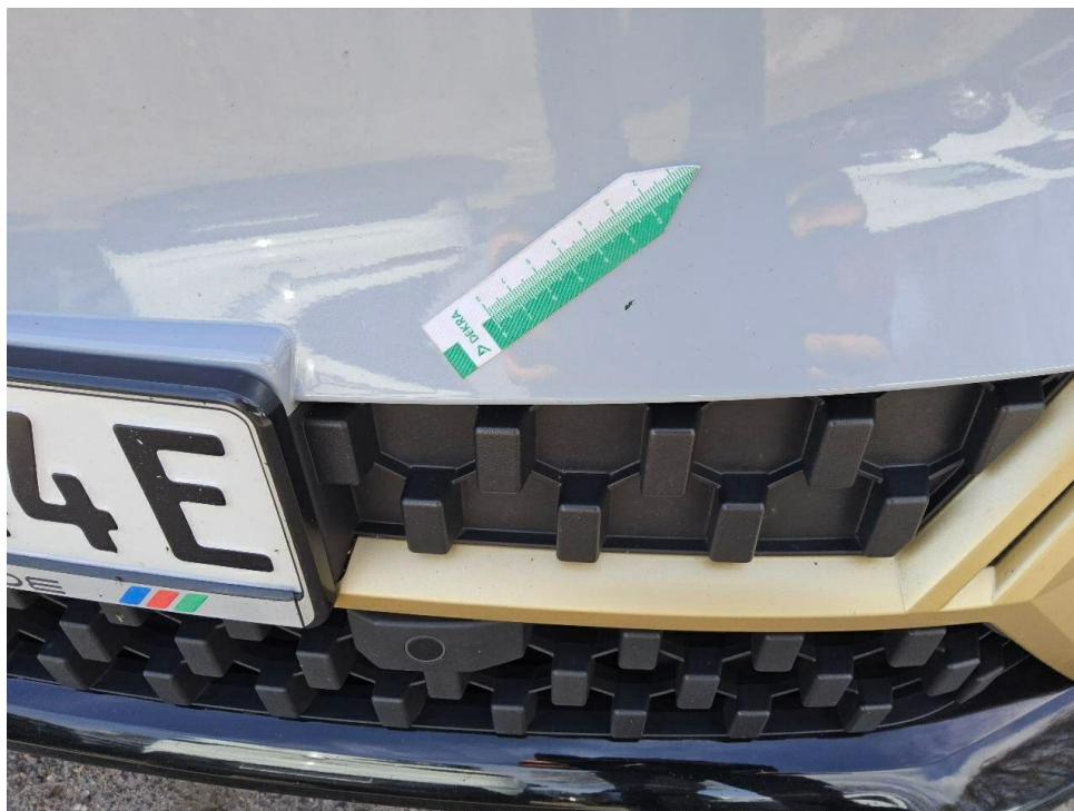
Bild 11 : Stoßfänger vorne Lackierung, Steinschlag, smart repair
