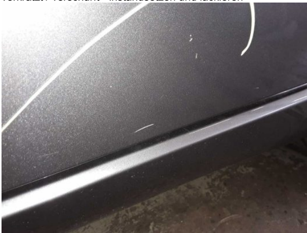
Beschädigung #11: Tür hinten links: Tür - verkratzt / verschürft - instandsetzen und lackieren
