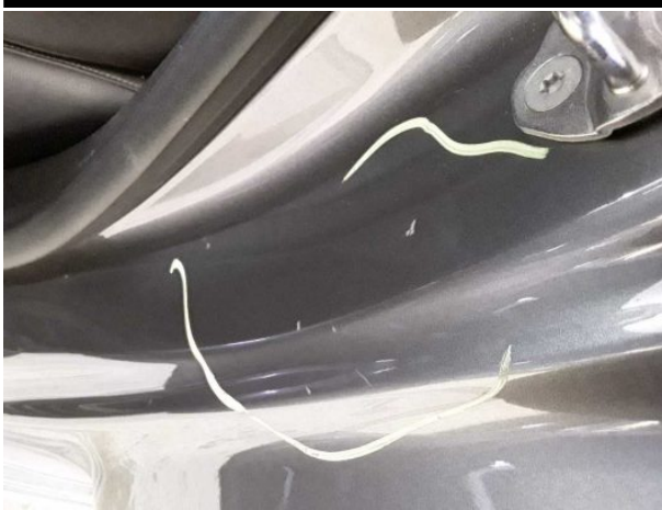
Beschädigung #6: Seitenwand links: Einstieg - Delle / Lackschaden - instandsetzen und lackieren
