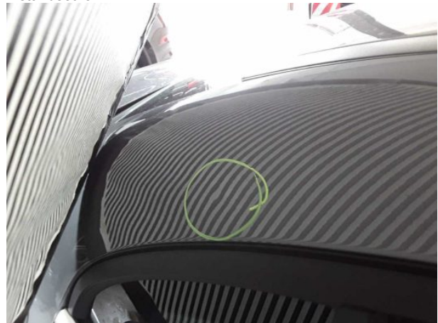
Beschädigung #5: Fahrzeugdach: Dachholm rechts - Delle(...) sanft instandsetzen
