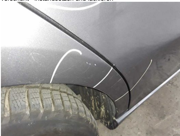
Beschädigung #15: Seitenwand rechts: Seitenwand - verkratzt / verschürft - instandsetzen und lackieren
