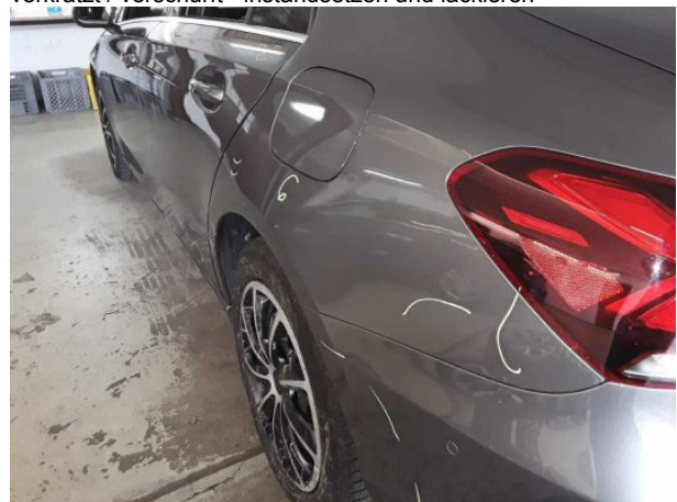
Beschädigung #14: Seitenwand links: Seitenwand - verkratzt / verschürft - instandsetzen und lackieren
