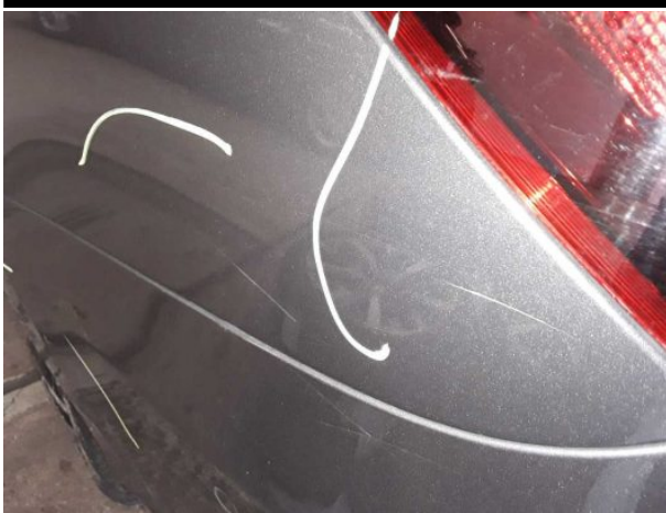
Beschädigung #14: Seitenwand links: Seitenwand - verkratzt / verschürft - instandsetzen und lackieren
