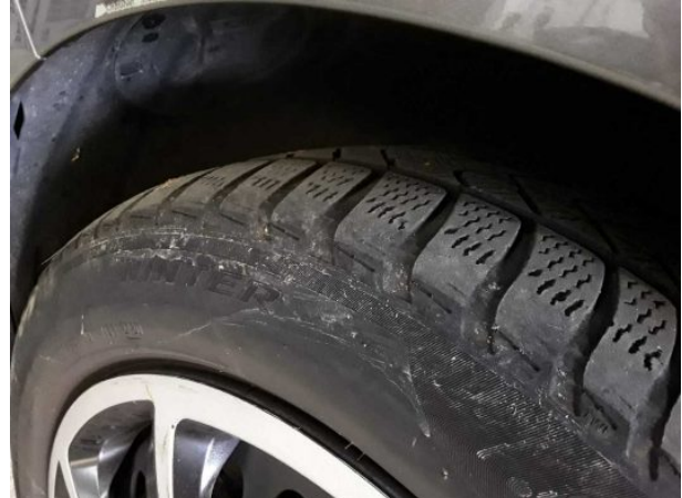
Beschädigung #3: Rad/Reifen: Reifen vorn - verschlissen - kein Abzug
