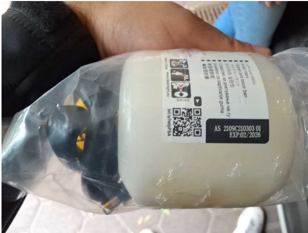
Beschädigung #1: Ausrüstung: Tirefit Füllmittel - abgelaufen - erneuern
