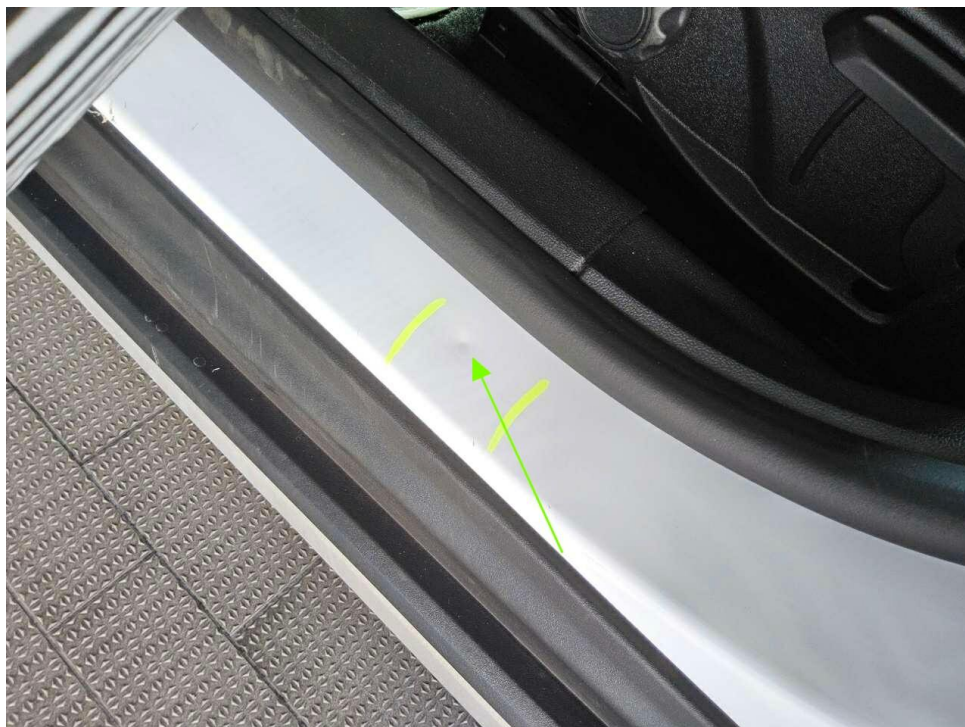
Bild 14 : Tür vorne links Einstieg, eingedellt, smart repair
