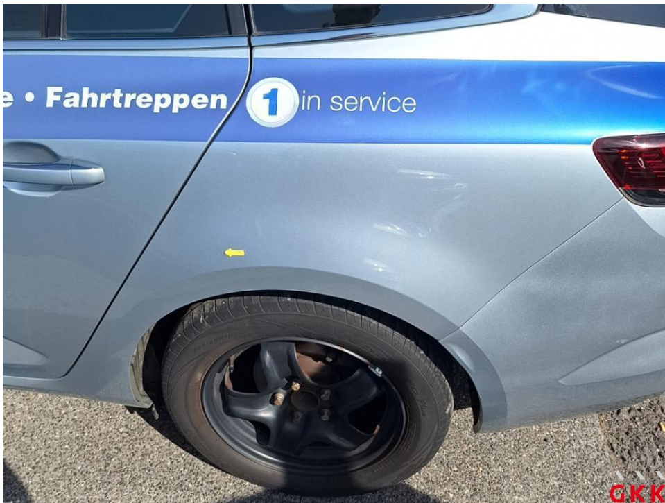
Bild 32. Seitenwand links, verkratzt, lackieren
