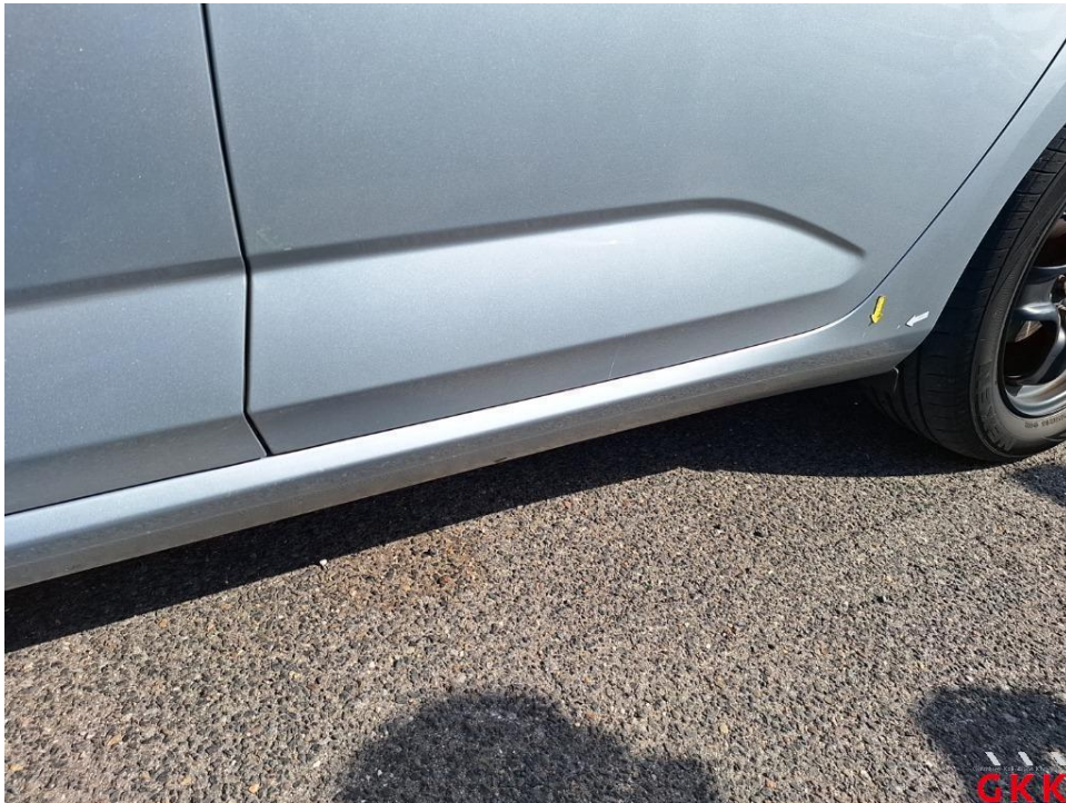
Bild 30. Schweller links, verkratzt, lackieren
