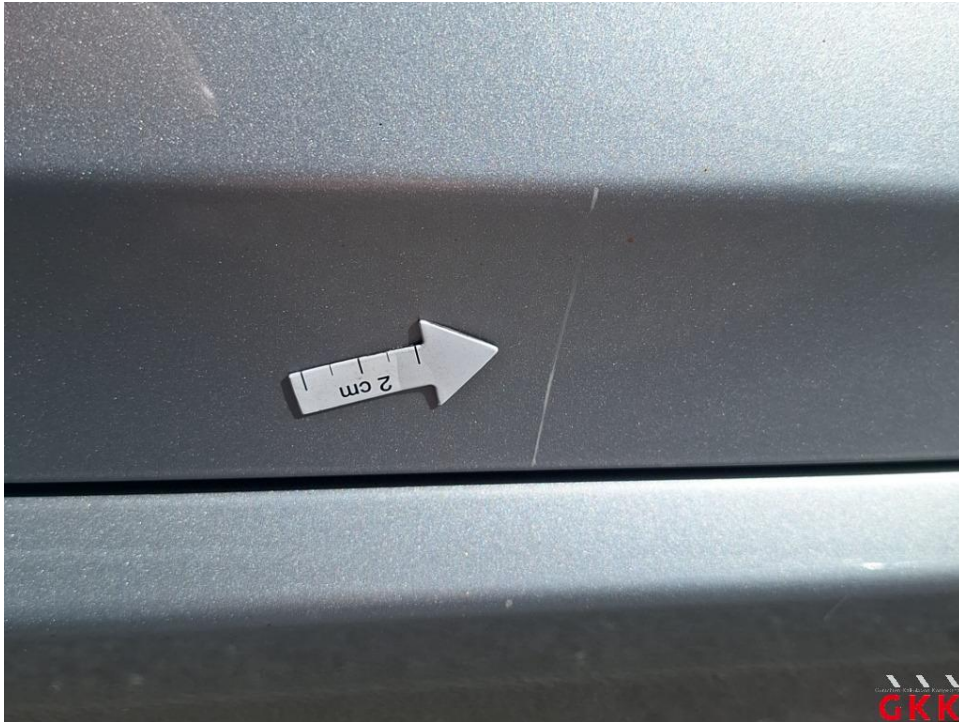
Bild 29. Tür hinten links, verkratzt, lackieren
