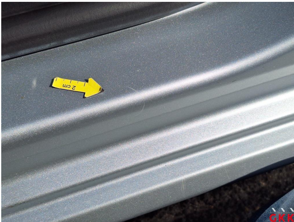
Bild 26. Tür vorne links, Einstieg, verkratzt, Smartrepair
