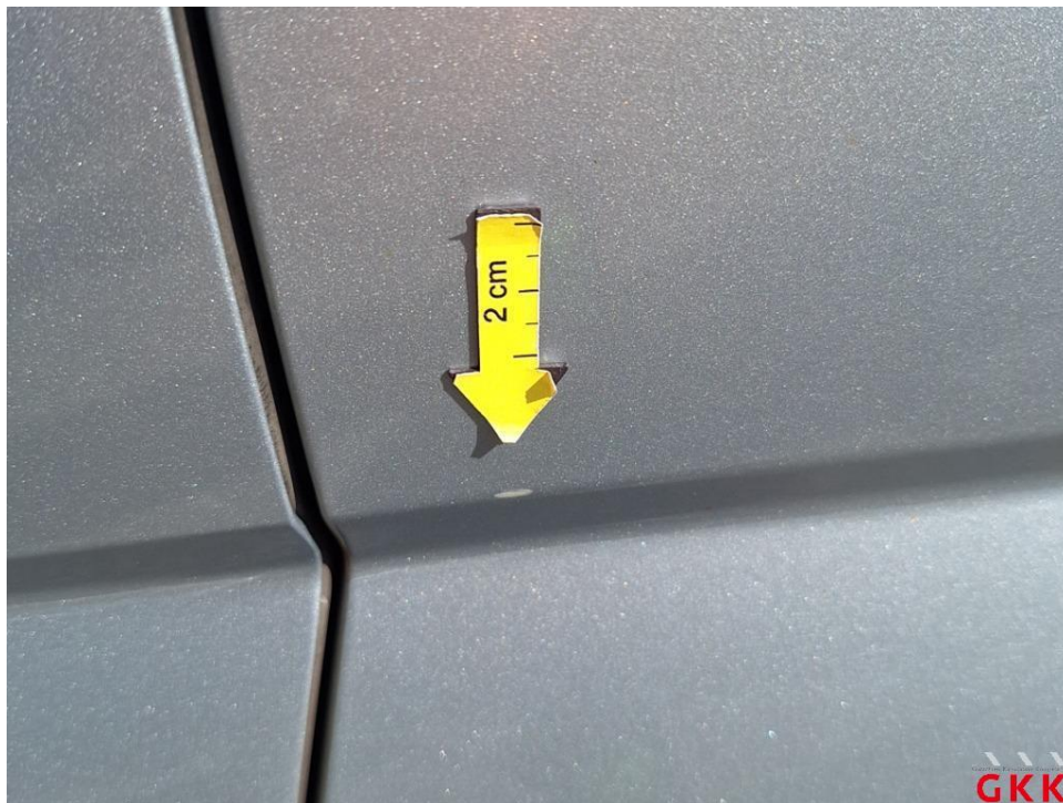
Bild 28. Tür hinten links, verkratzt, lackieren
