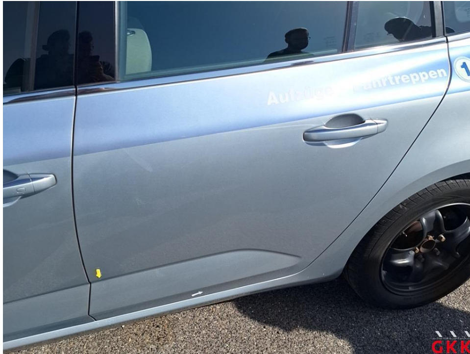
Bild 27. Tür hinten links, verkratzt, lackieren
