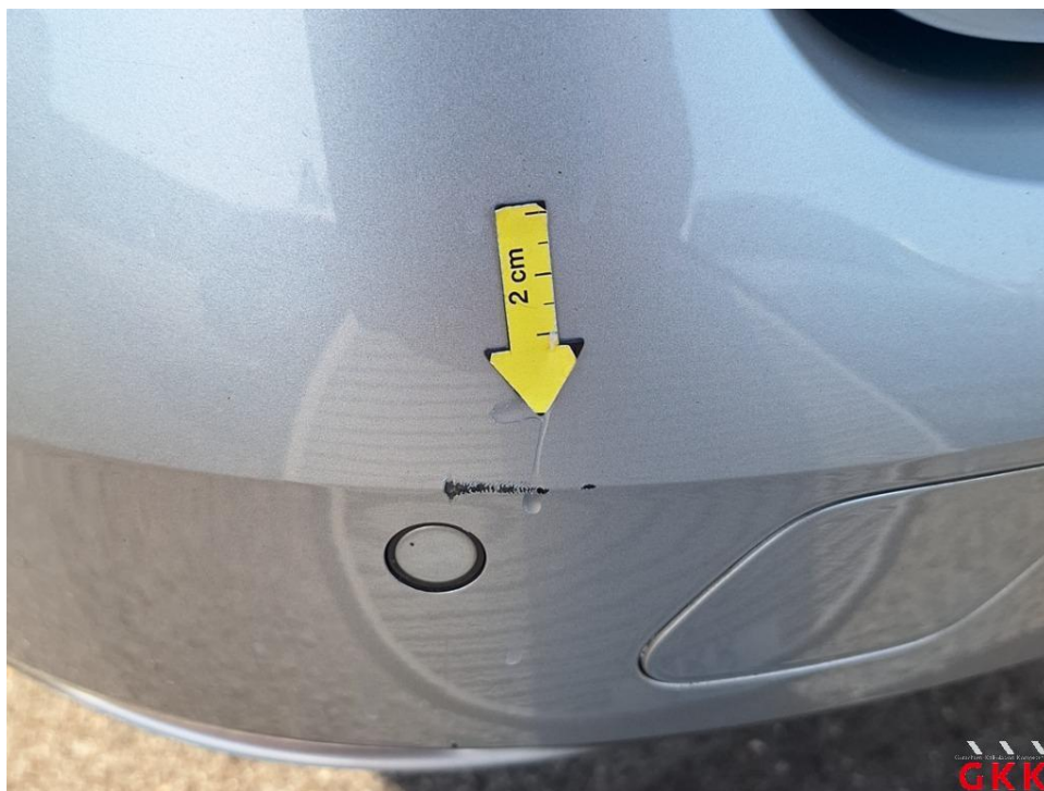
Bild 24. Stoßfänger hinten, Verkleidung -lackiert-, verkratzt, lackieren
