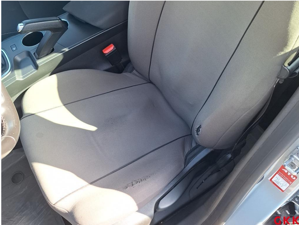
Bild 15. Sitz vorne links, Schonbezug, beschädigt, ersetzen
