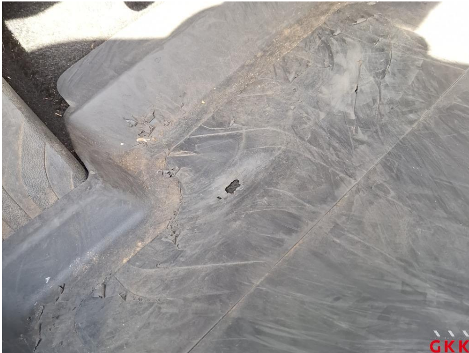
Bild 14. Fußmatte(n), vorne links, beschädigt, ersetzen
