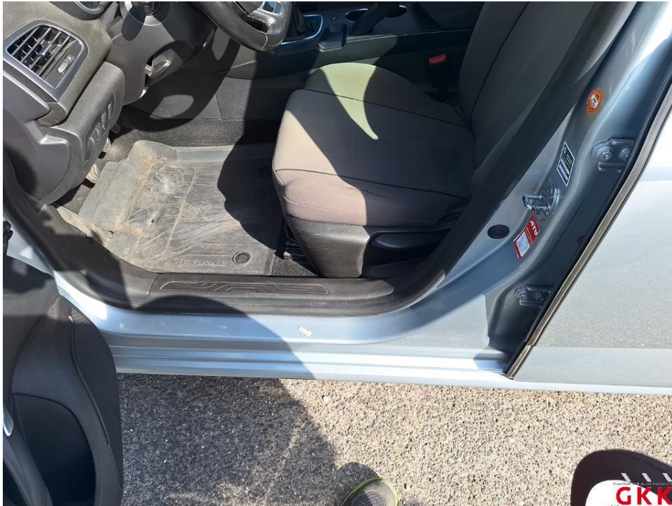
Bild 25. Tür vorne links, Einstieg, verkratzt, Smartrepair
