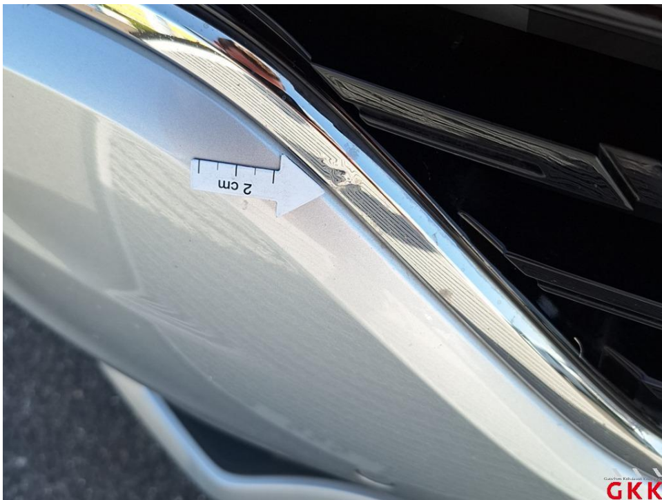
Bild 20. Frontgrill, Chrom, beschädigt, ersetzen
