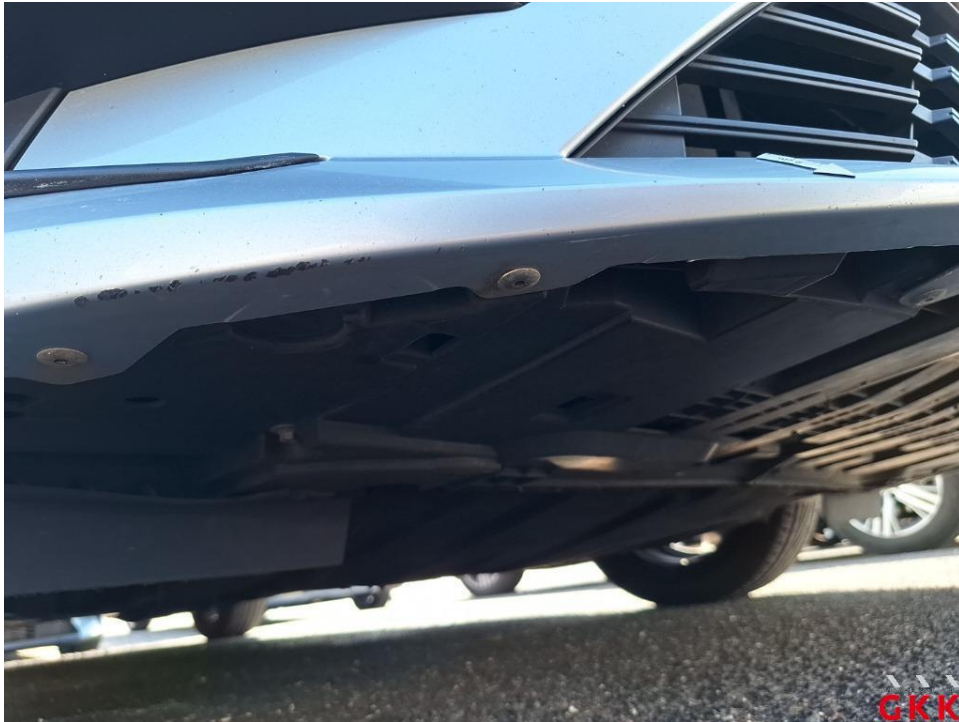
Bild 17. Stoßfänger vorne, Verkleidung -lackiert-, verkratzt, lackieren
