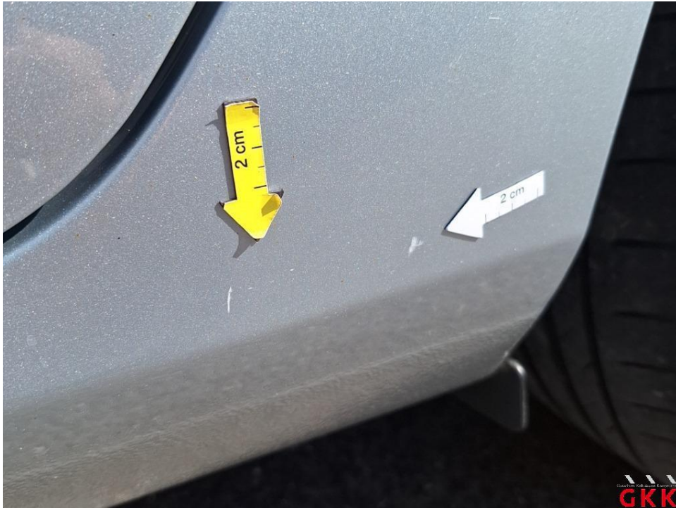
Bild 31. Schweller links, verkratzt, lackieren
