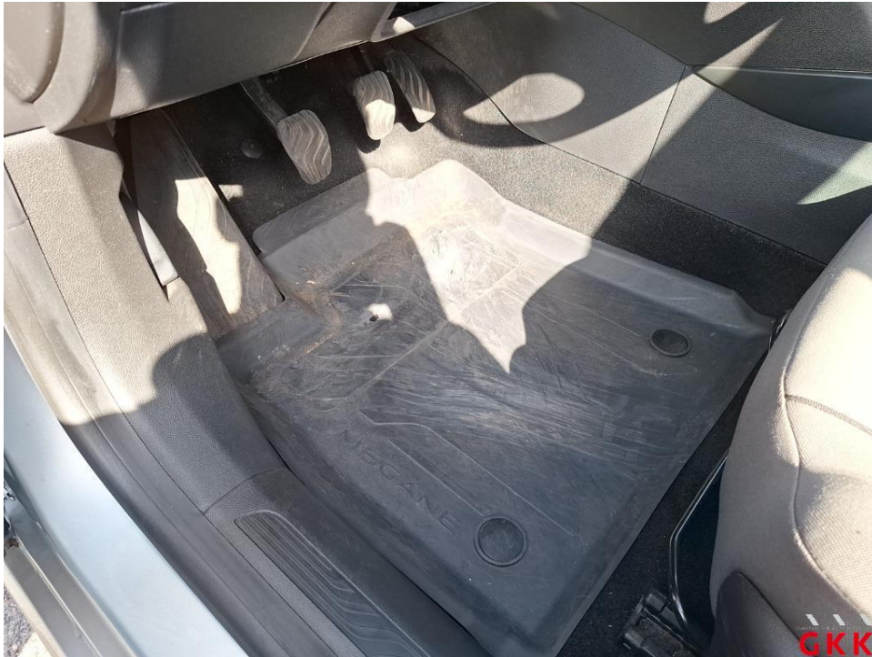
Bild 13. Fußmatte(n), vorne links, beschädigt, ersetzen
