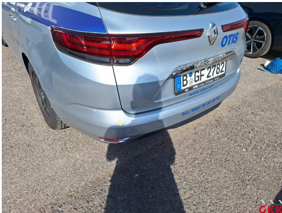
Bild 23. Stoßfänger hinten, Verkleidung -lackiert-, verkratzt, lackieren
