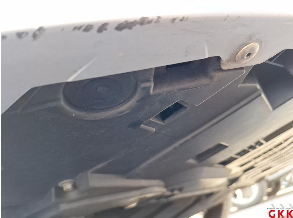
Bild 18. Stoßfänger vorne, Verkleidung -lackiert-, verkratzt, lackieren
