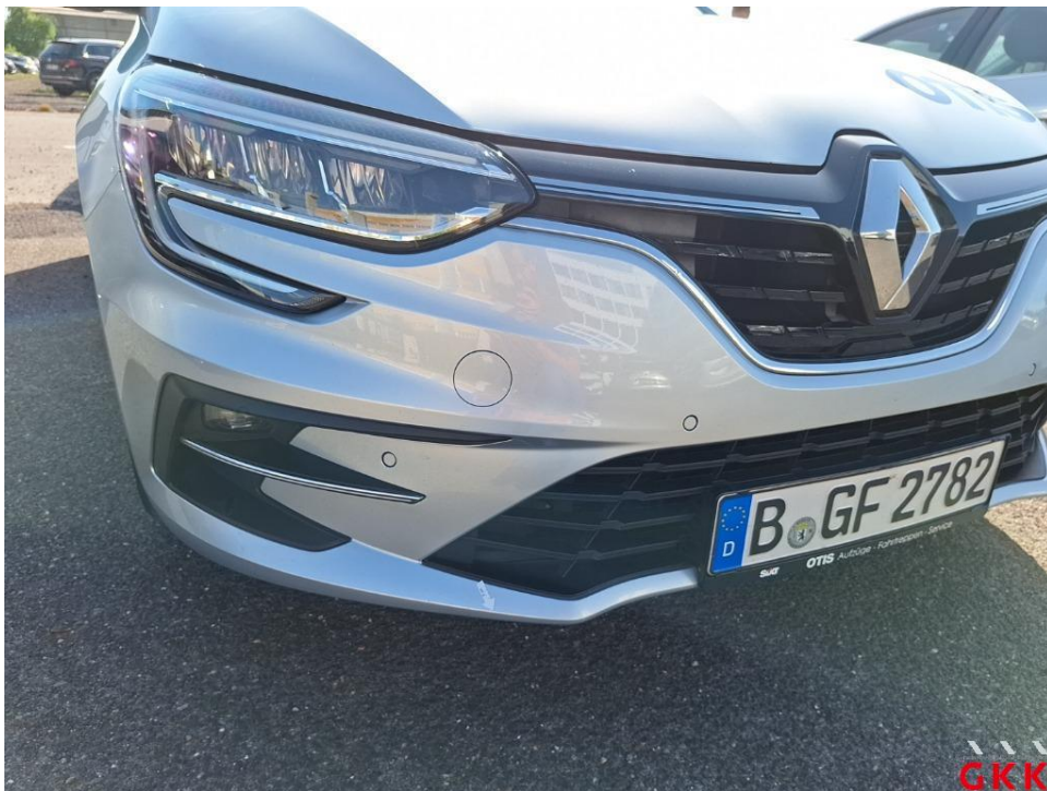
Bild 16. Stoßfänger vorne, Verkleidung -lackiert-, verkratzt, lackieren
