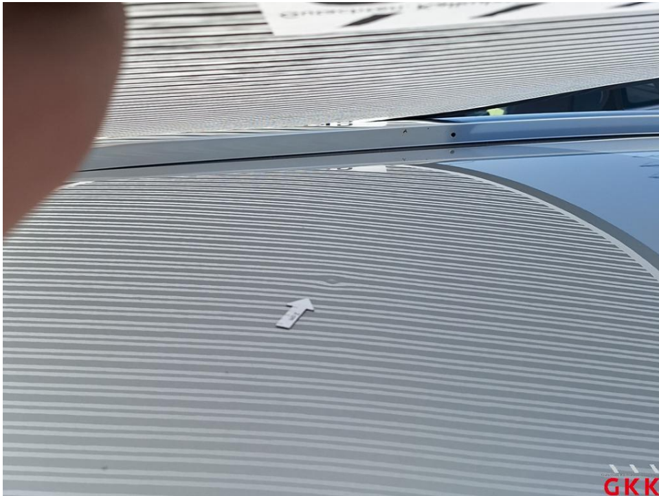
Bild 22. Dach, bis 3 Dellen / Bauteil, kalt drücken
