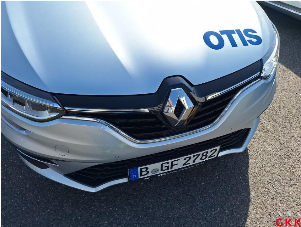
Bild 19. Frontgrill, Chrom, beschädigt, ersetzen
