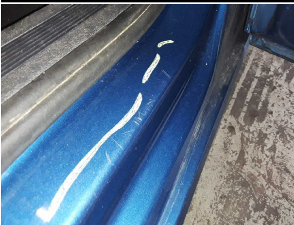
Beschädigung #6: Seitenwand rechts: Einstieg - verkratzt / verschürft - Smart Repair
