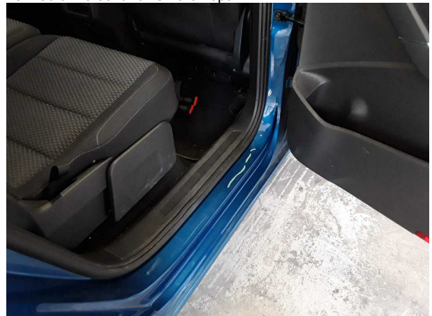
Beschädigung #6: Seitenwand rechts: Einstieg - verkratzt / verschürft - Smart Repair
