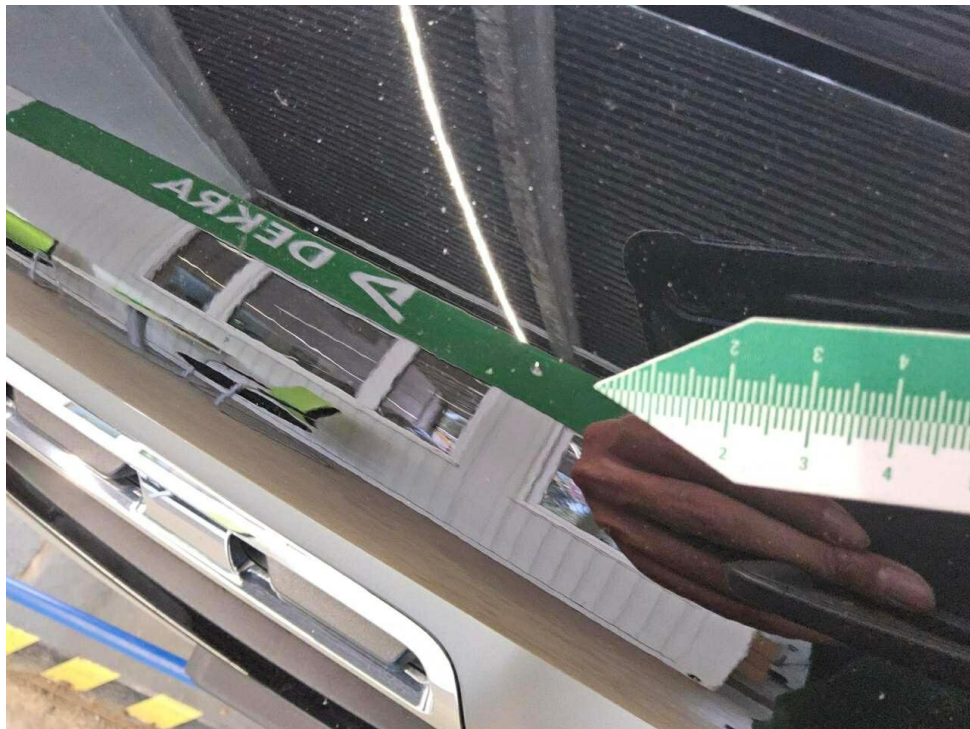
Bild 22 : Stoßfänger vorne Lackierung, Steinschlag, Gebrauchsspur
