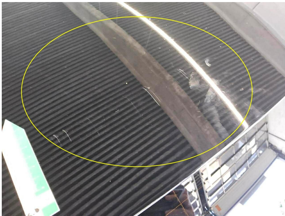
Bild 18 : Heckspoiler Lackierung, verschrammt, Gebrauchsspur
