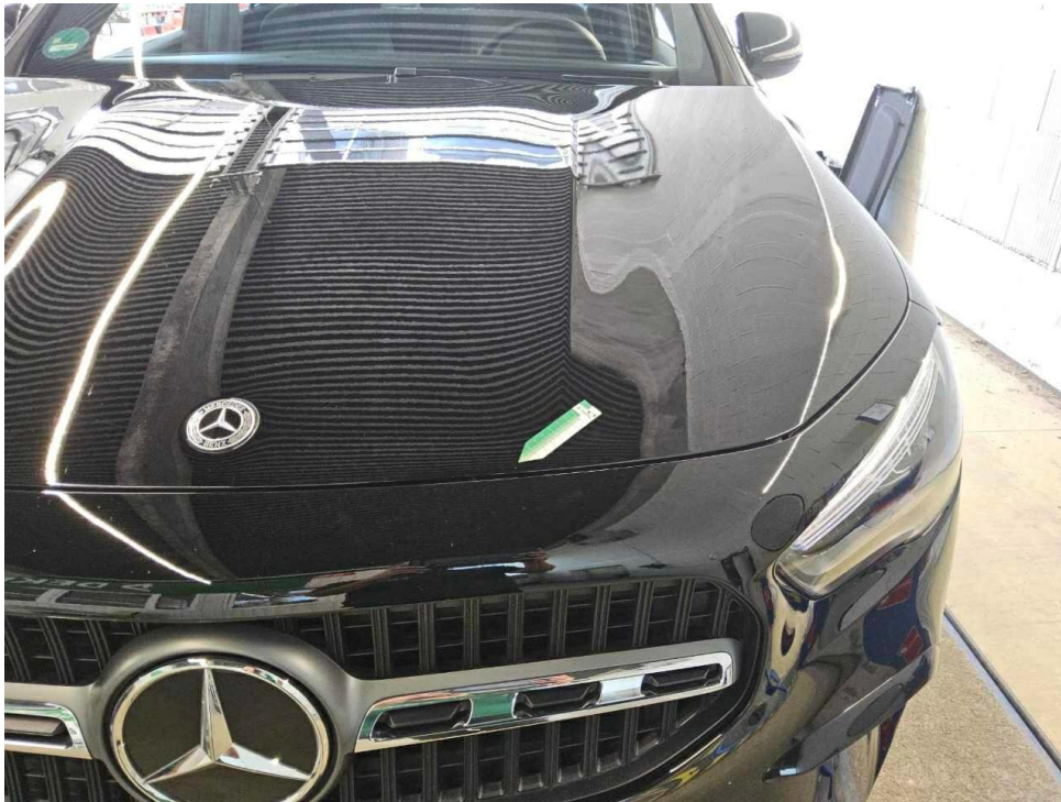
Bild 23 : Motorhaube Lackierung, Steinschlag, Gebrauchsspur
