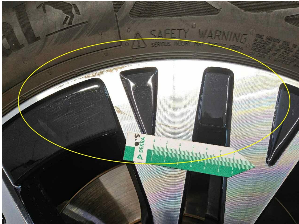
Bild 25 : LM Felge vorne links glanzgedreht verschrammt, Sommer
