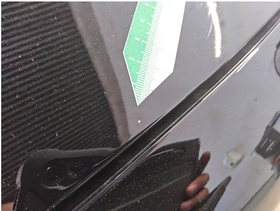
Bild 24 : Motorhaube Lackierung, Steinschlag, Gebrauchsspur
