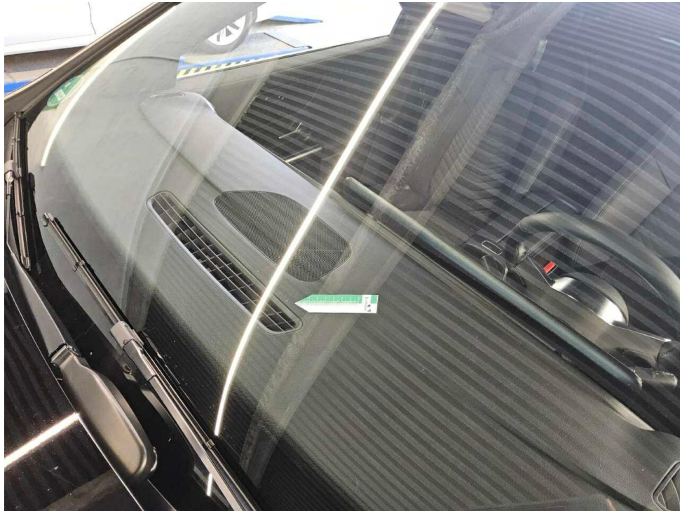
Bild 19 : Frontscheibe, Steinschlag, Gebrauchsspur
