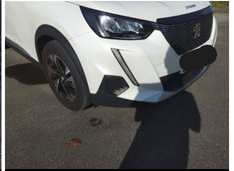
Grille de pare-chocs / Avant Droit / Rayure
