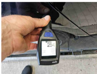
Lackstärke Seitenwand hinten rechts
