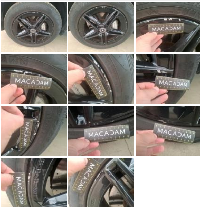
Jante alum. AVD, Griffe(s), Réparer/rempl. (montant forfaitaire)
