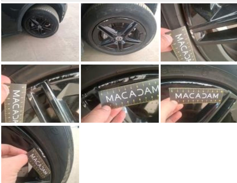
Jante alum. ARD, Griffe(s), Réparer/rempl. (montant forfaitaire)
