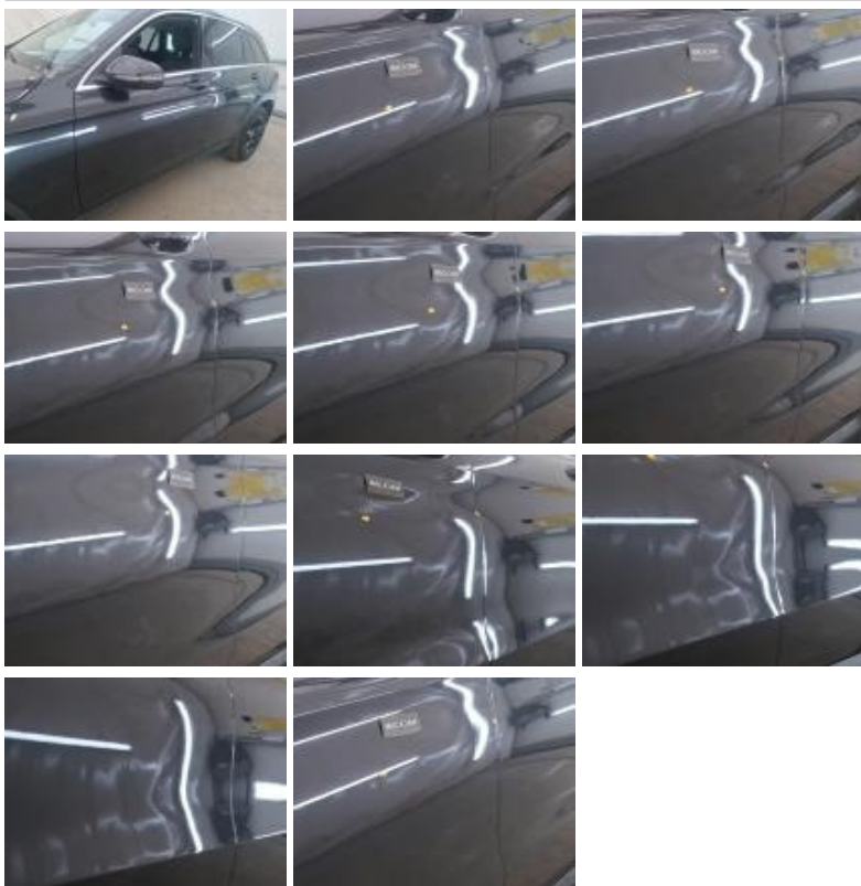
Porte ARD, Mauvaise réparation, Peindre
