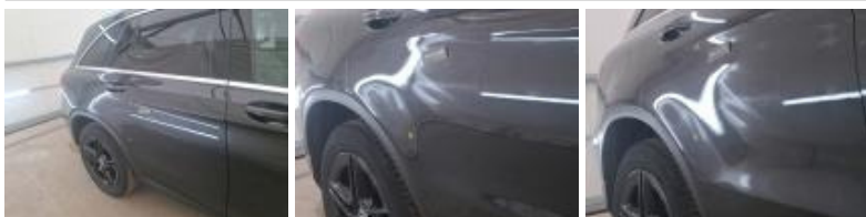
Porte ARD, Mauvaise réparation, Peindre
