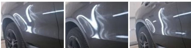
Porte AVD, Mauvaise réparation, Peindre
