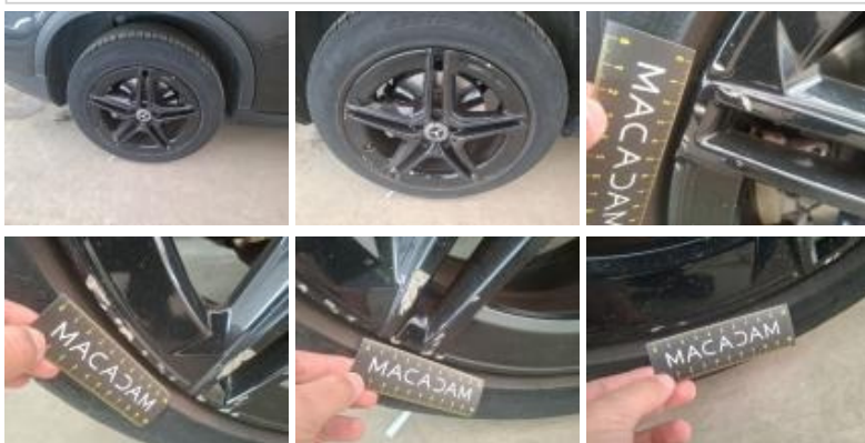
Jante alum. ARD, Griffe(s), Réparer/rempl. (montant forfaitaire)
