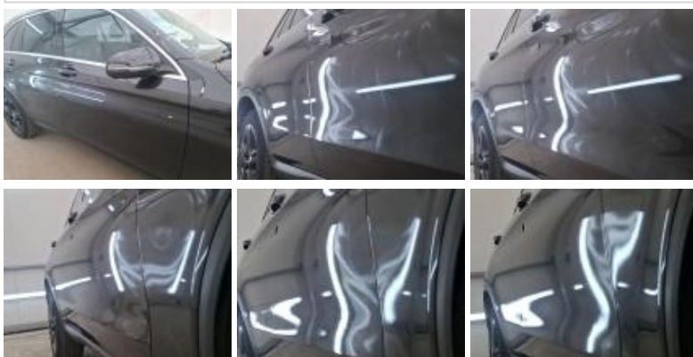
Porte AVD, Mauvaise réparation, Peindre
