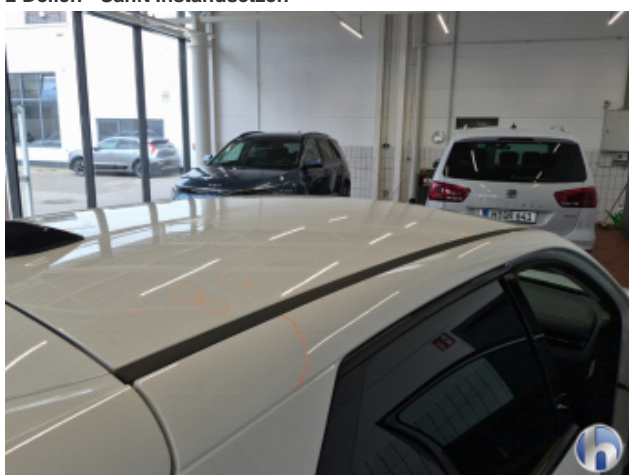
4. Dach Dellen / Beulen - Sanft Instandsetzen
