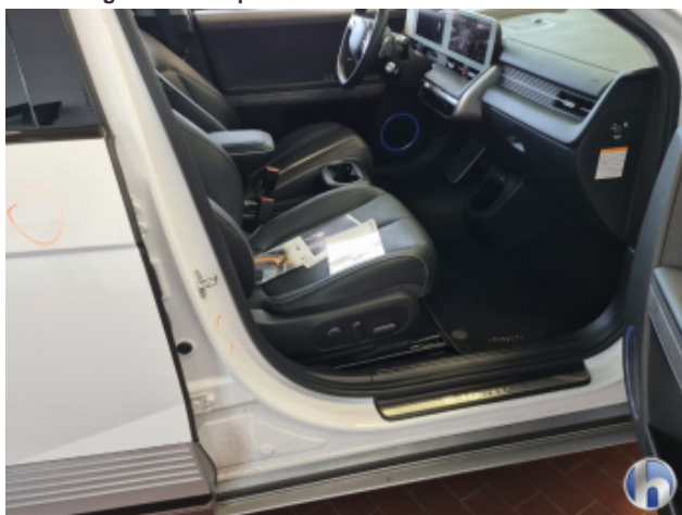
2. Türeinstieg Vorne - Rechts Beschädigt - Smart Repair
