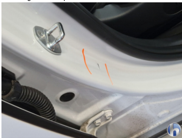
2. Türeinstieg Vorne - Rechts Beschädigt - Smart Repair
