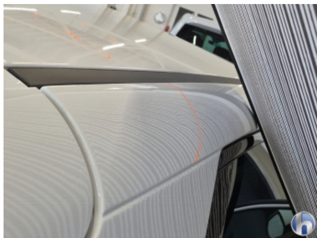
3. Dachrahmen - Rechts 2 Dellen - Sanft Instandsetzen
