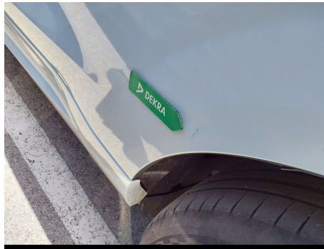
Puerta / Trasero Izquierdo / Abolladura
