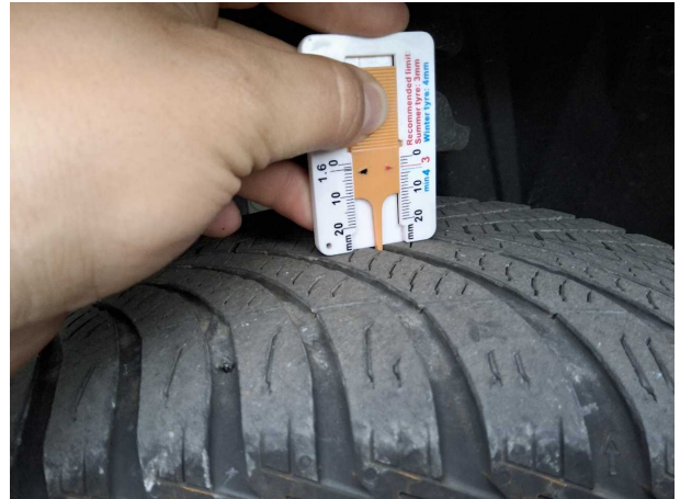
Beschädigung #6: Rad/Reifen: Reifensatz komplett - verschlissen - erneuern
