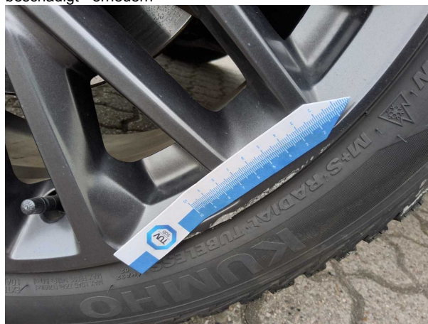
Beschädigung #5: Rad/Reifen: Leichtmetallfelge vorn rechts - beschädigt - erneuern
