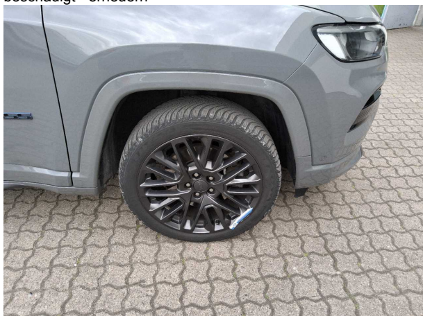
Beschädigung #5: Rad/Reifen: Leichtmetallfelge vorn rechts - beschädigt - erneuern
