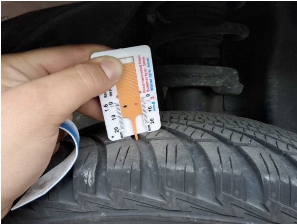
Beschädigung #6: Rad/Reifen: Reifensatz komplett - verschlissen - erneuern
