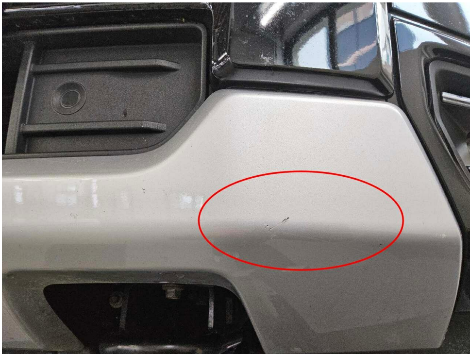
Bild 20 : Frontspoiler Lackierung, zerkratzt, lackieren
