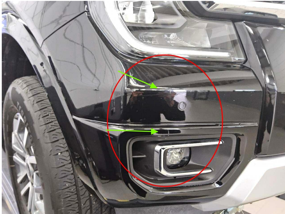
Bild 17 : Stoßfänger vorne Lackierung, zerkratzt, lackieren
