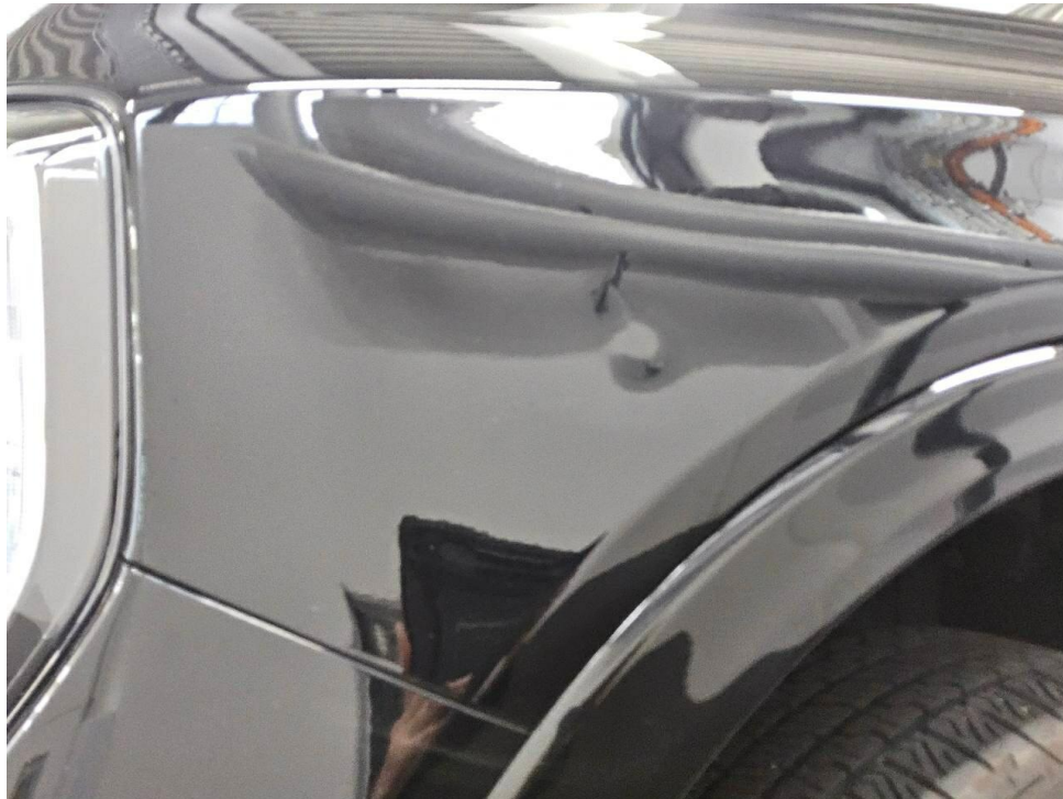
Bild 15 : Kotflügel vorne links, deformiert, instandsetzen und lackieren mit Lackaufbau
