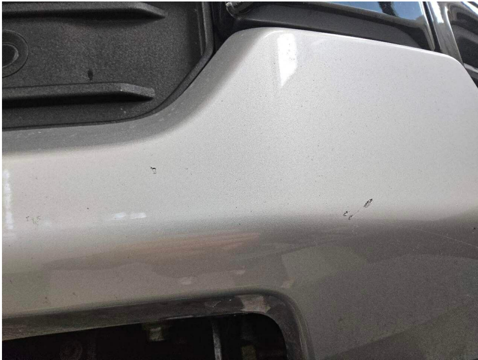
Bild 21 : Frontspoiler Lackierung, zerkratzt, lackieren
