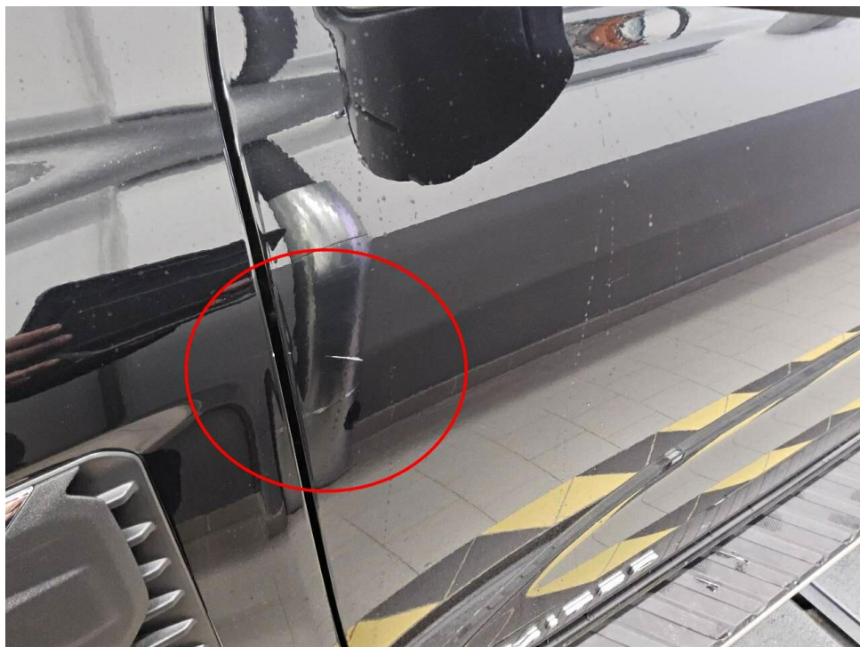
Bild 16 : Tür vorne links Lackierung, zerkratzt, lackieren
