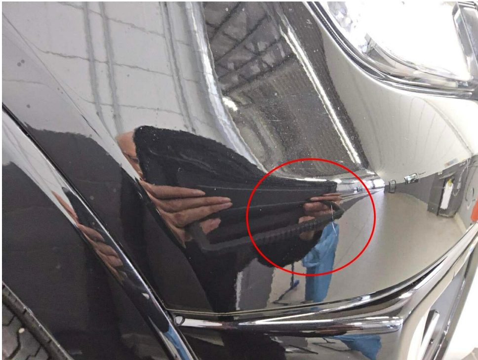
Bild 19 : Stoßfänger vorne Lackierung, zerkratzt, lackieren
