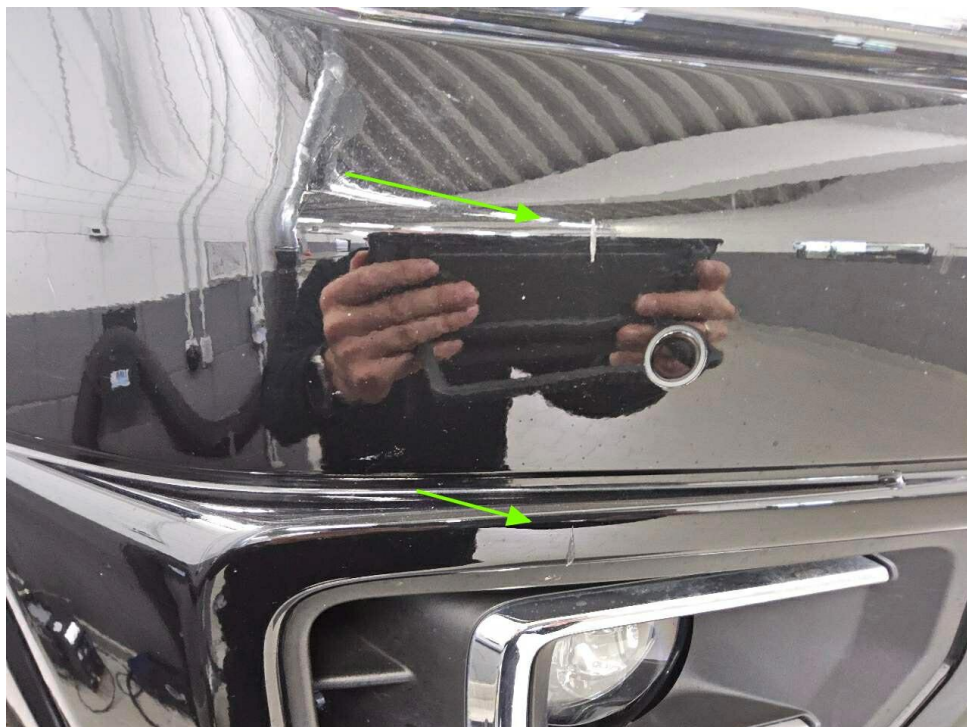
Bild 18 : Stoßfänger vorne Lackierung, zerkratzt, lackieren
