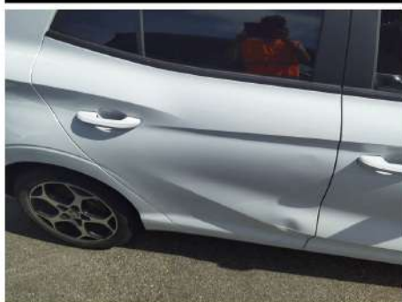
Porta / Posteriore Destro / Ammaccato vernice incisa
