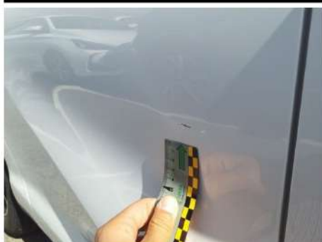
Porta / Posteriore Destro / Ammaccato vernice incisa
