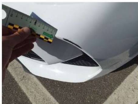
Paraurti / Anteriore / Ammaccato vernice incisa
