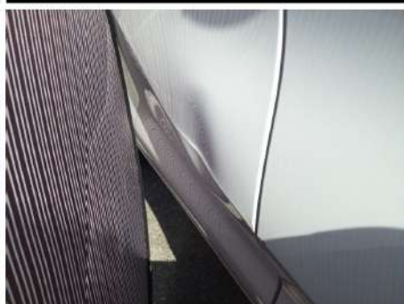
Porta / Posteriore Destro / Ammaccato vernice incisa
