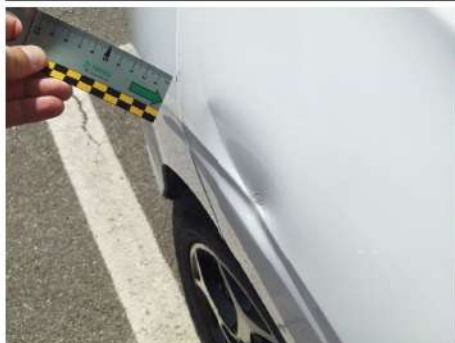
Parafango / Anteriore Sinistro / Ammaccato vernice incisa
