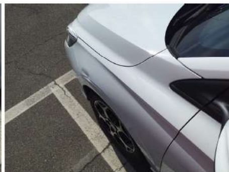
Parafango / Anteriore Sinistro / Ammaccato vernice incisa
