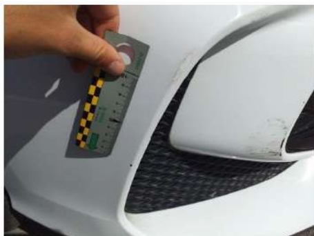
Paraurti / Anteriore / Ammaccato vernice incisa
