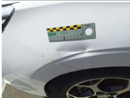
Parafango / Anteriore Sinistro / Ammaccato vernice incisa
