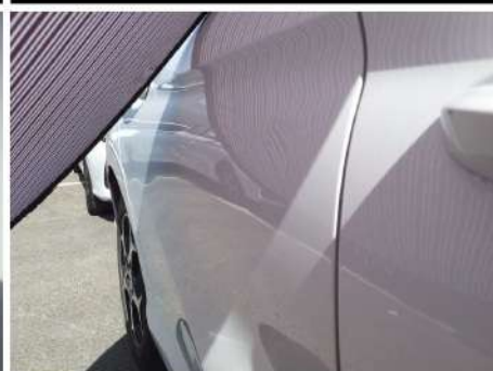
Porta / Posteriore Destro / Ammaccato vernice incisa
