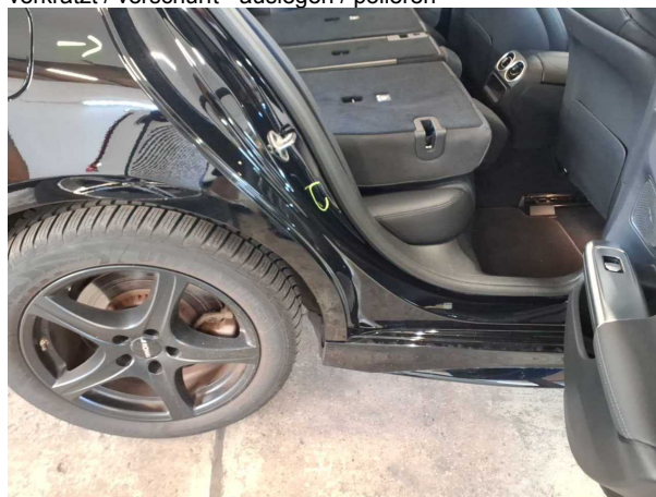
Beschädigung #4: Seitenwand rechts: Einstieg - Delle(n) - sanft instandsetzen
