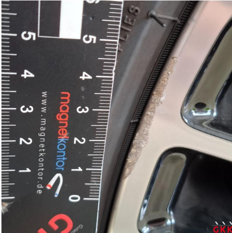
Bild 15. LM-Rad, vorne rechts, Materialabtrag, ersetzen
