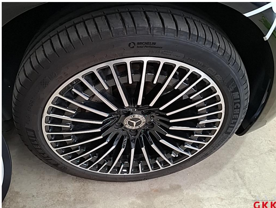
Bild 13. LM-Rad, vorne rechts, Materialabtrag, ersetzen
