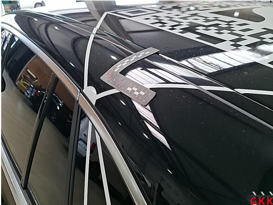
Bild 25. Dach, Holm links, beschädigt, Smartrepair
