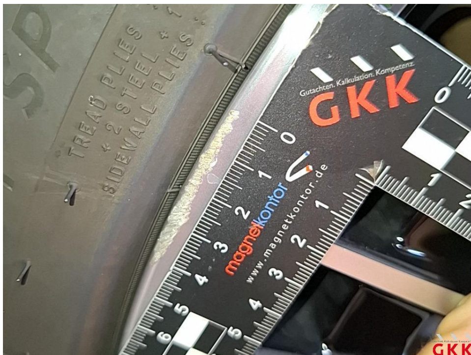
Bild 14. LM-Rad, vorne rechts, Materialabtrag, ersetzen
