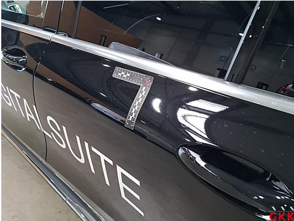
Bild 31. Tür hinten links, bis 3 Dellen / Bauteil, Smartrepair
