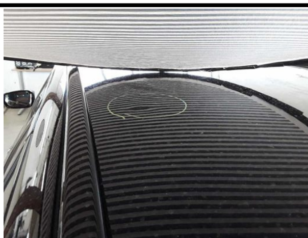
Beschädigung #5: Fahrzeugdach: Dach - Delle(n) - sanft instandsetzen
