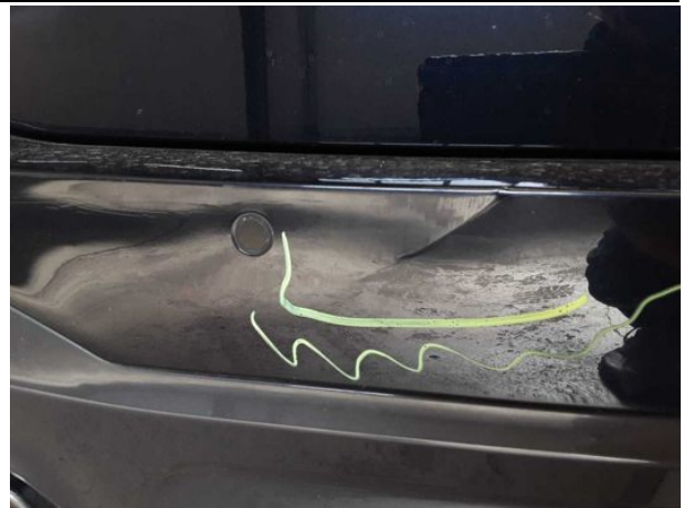
Beschädigung #12: Stossfänger hinten: Stossfänger hinten - verformt - erneuern
