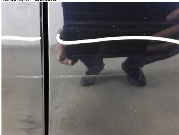
Beschädigung #11: Tür vorn rechts: Tür - verkratzt / verschürft - lackieren
