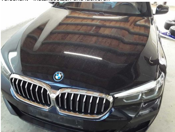
Beschädigung #10: Motorhaube: Motorhaube - verkratzt / verschürft - lackieren
