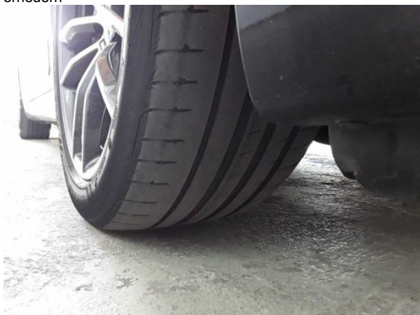
Beschädigung #4: Rad/Reifen: Reifen vorn - verschlissen - erneuern
