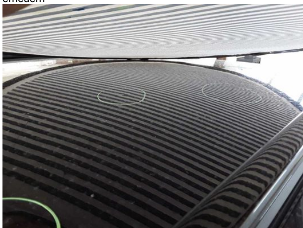
Beschädigung #5: Fahrzeugdach: Dach - Delle(n) - sanft instandsetzen
