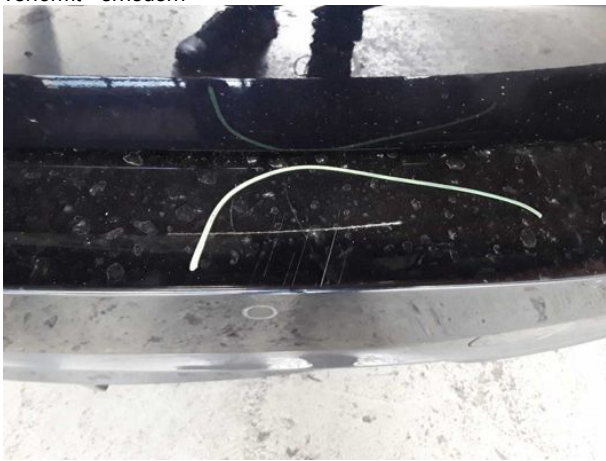
Beschädigung #12: Stossfänger hinten: Stossfänger hinten - verformt - erneuern
