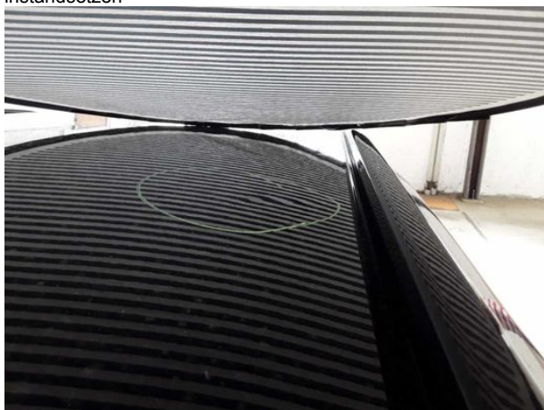
Beschädigung #5: Fahrzeugdach: Dach - Delle(n) - sanft instandsetzen
