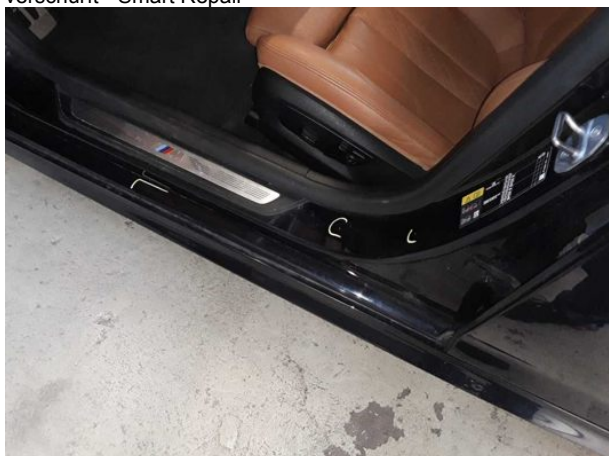
Beschädigung #2: Schweller links: Einstieg - verkratzt / verschürft - Smart Repair
