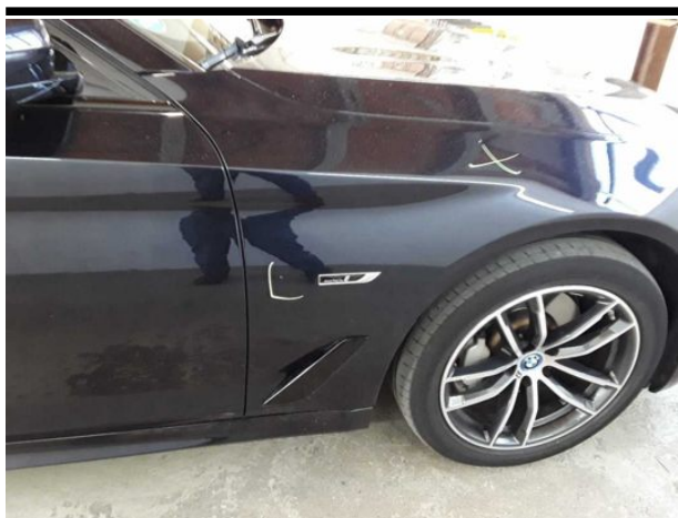
Beschädigung #7: Kotflügel rechts: Kotflügel rechts - verkratzt / verschürft - lackieren
