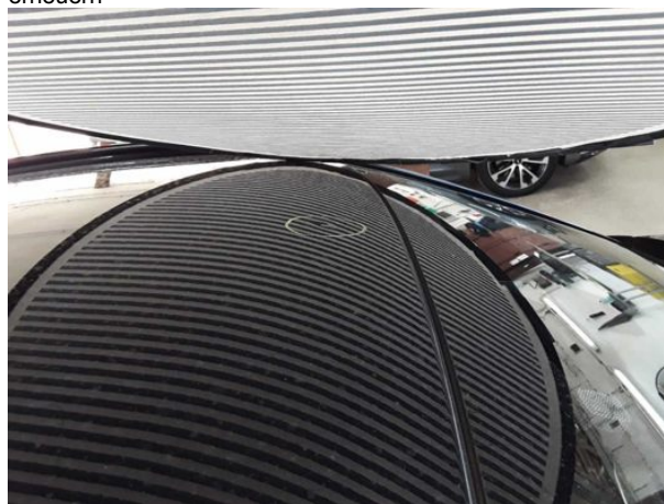
Beschädigung #5: Fahrzeugdach: Dach - Delle(n) - sanft instandsetzen
