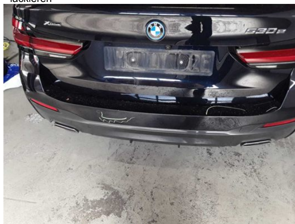
Beschädigung #12: Stoßfänger hinten: Stoßfänger hinten - verformt - erneuern
