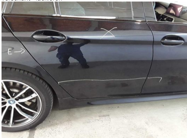
Beschädigung #8: Tür hinten rechts: Tür - verkratzt / verschürft - lackieren
