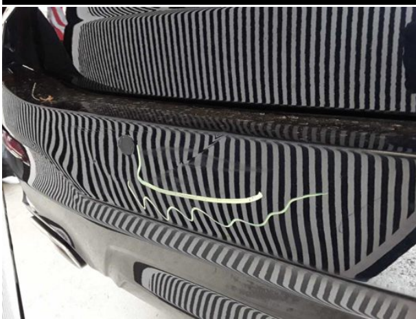
Beschädigung #12: Stossfänger hinten: Stossfänger hinten - verformt - erneuern
