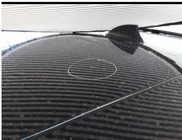
Beschädigung #5: Fahrzeugdach: Dach - Delle(n) - sanft instandsetzen
