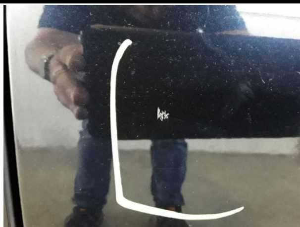
Beschädigung #7: Kotflügel rechts: Kotflügel rechts - verkratzt / verschürft - lackieren
