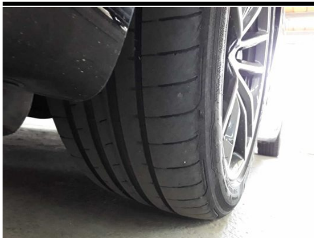
Beschädigung #4: Rad/Reifen: Reifen vorn - verschlissen - erneuern
