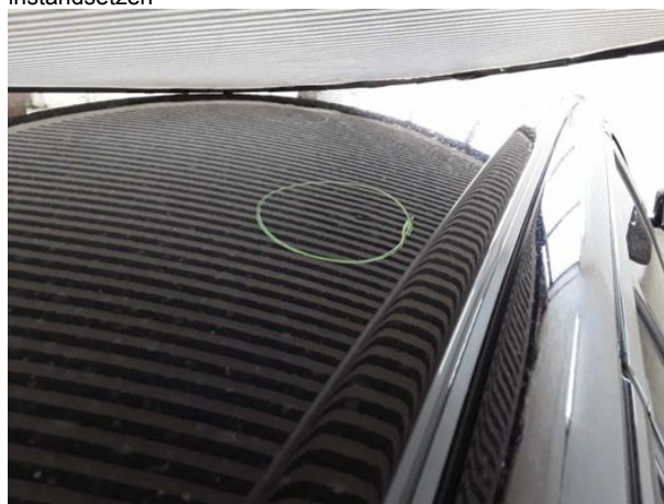
Beschädigung #5: Fahrzeugdach: Dach - Delle(n) - sanft instandsetzen
